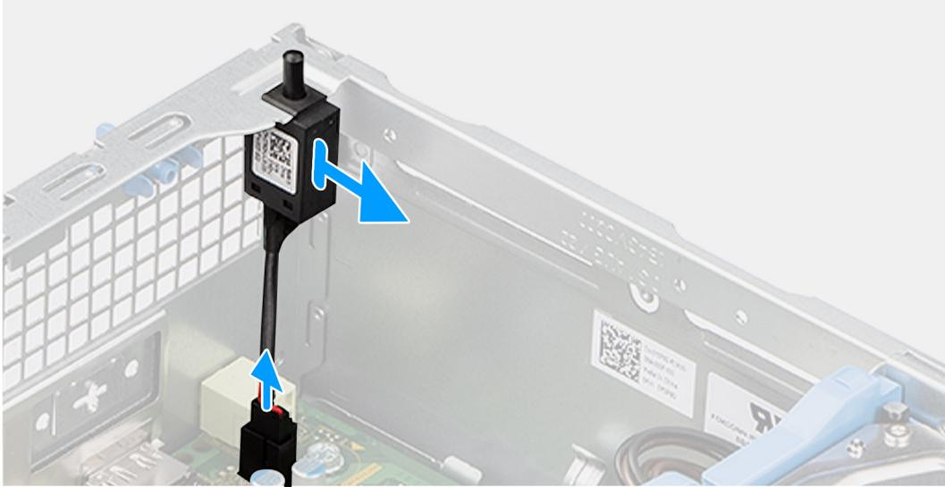
**Figura 33. Rimozione dell'interruttore di intrusione**
