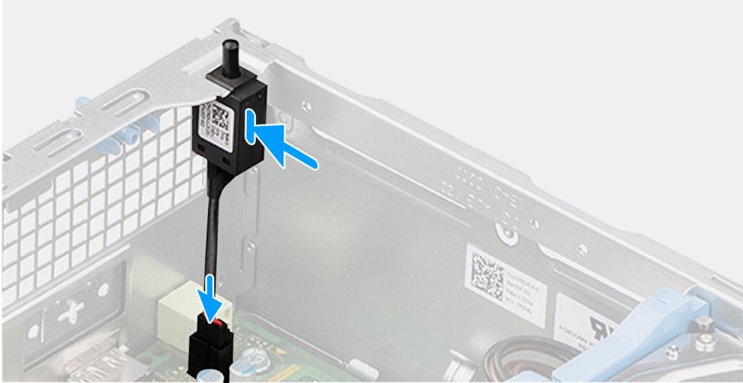
**Figura 34. Installazione dello switch antintrusione**
