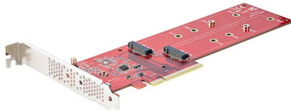
Questo doppio adattatore PCIe M.2 consente di aggiungere due SSD PCIe M.2 (NVMe e AHCI) ad alte prestazioni nello slot PCIe x8 o x16 di un desktop, una workstation o un server.
