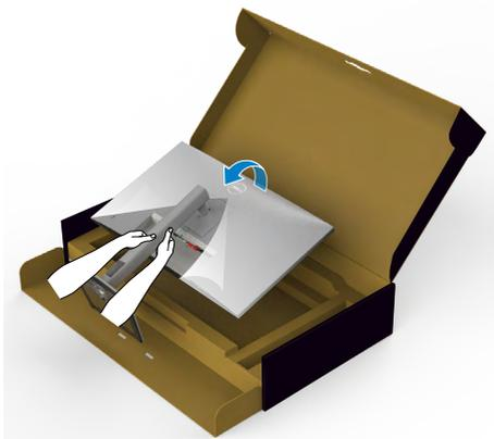
**NOTA: Tenere saldamente il montante del supporto quando si solleva il monitor per evitare danni accidentali.**
