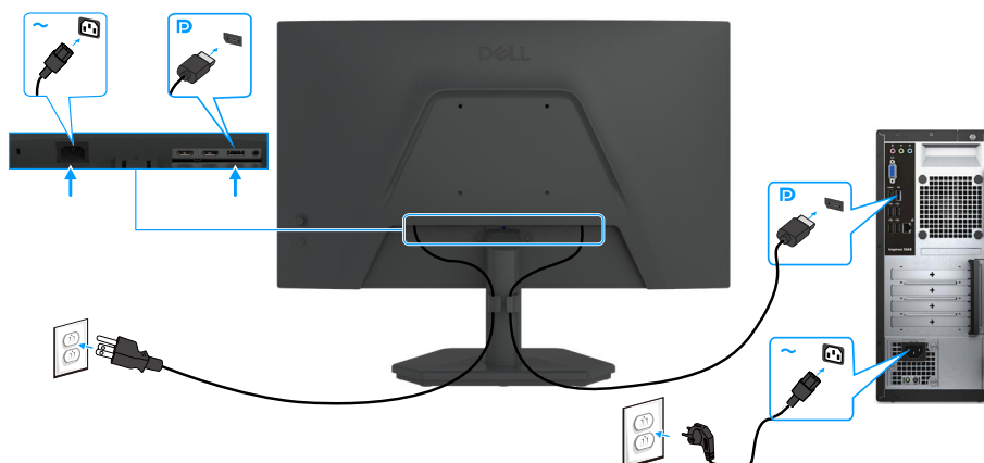
Figura 15. Collegamento del cavo DisplayPort
