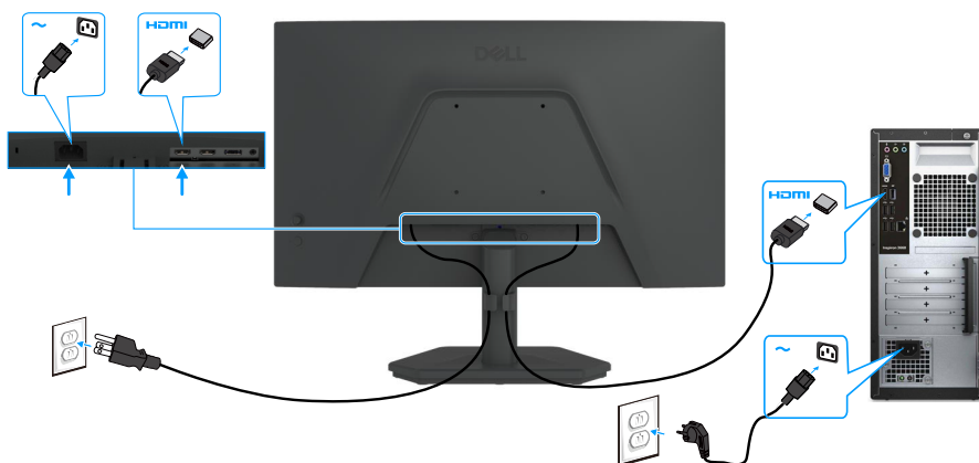
Figura 14. Collegamento del cavo HDMI
