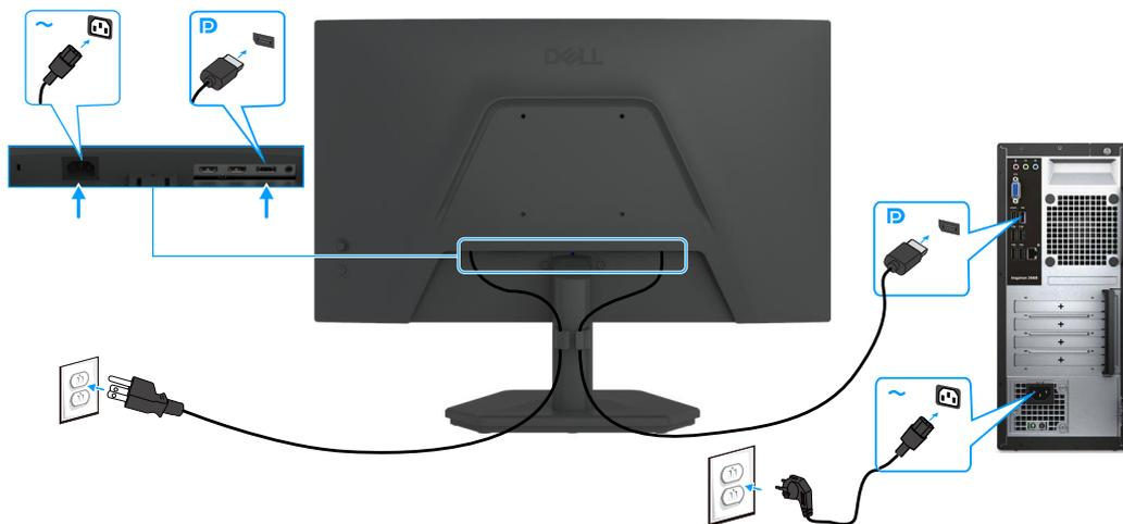
Figura 7. Collegamento del cavo DisplayPort
