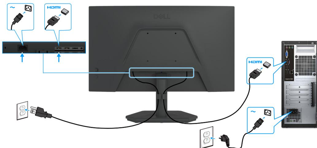
Figura 6. Collegamento del cavo HDMI
