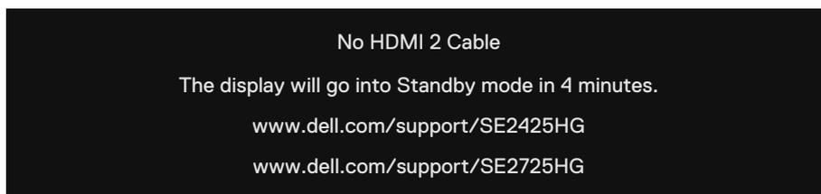
**Figura 26. Messaggio di avviso: cavo HDMI 2 non collegato**
