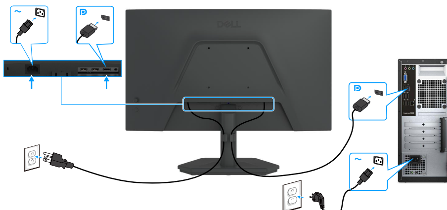
Figura 15. Collegamento del cavo DisplayPort
