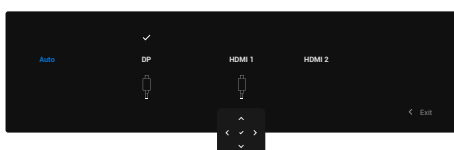
Figura 29. Selezione automatica della sorgente di ingresso
