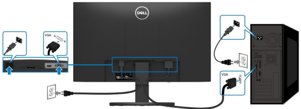
Figura 6. Collegamento del cavo VGA
