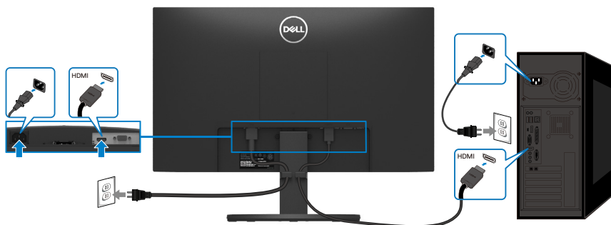
Figura 18. Collegamento del cavo HDMI
