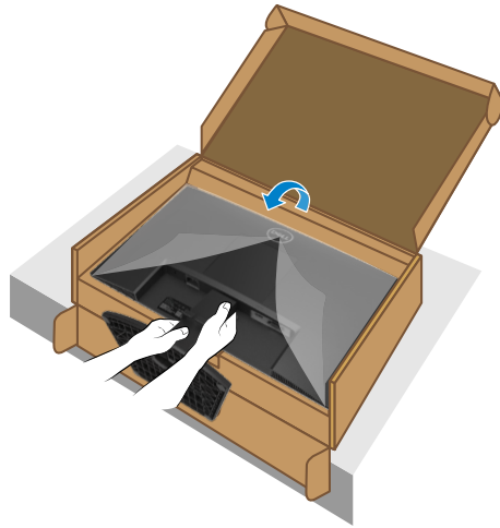
Figura 15. Tenere il supporto e sollevare il monitor
