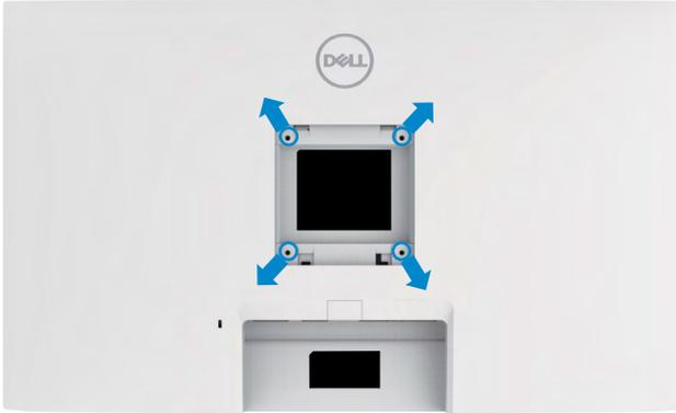
**NOTA: Utilizzare viti M4 x 11 mm per collegare il monitor al kit di installazione a parete.**
