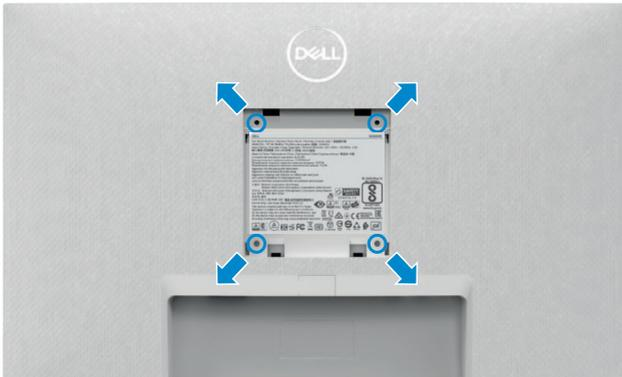
**NOTA:** Utilizzare viti M4 x 10 mm per collegare il monitor al kit di installazione a parete.
