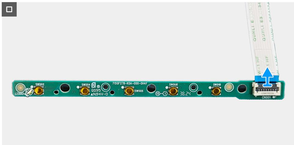
**Figura 10.** Rimozione della scheda del tastierino
