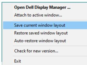
Nel caso in cui sia necessario sostituire un display in una configurazione di matrice del display, è possibile salvare il layout delle finestre prima della sostituzione e ripristinare il layout dopo l'installazione di un nuovo display.
