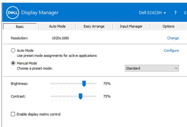
**NOTA:** Quando si collegano più display Dell, selezionare “Enable display matrix control” (Abilita controllo matrice schermo) per applicare i controlli di luminosità, contrasto e preimpostazioni di colore a tutti i display.
