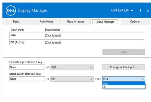
**NOTA:** DDM comunica con il display anche quando il display visualizza video di un altro computer. È possibile installare DDM sul computer utilizzato di frequente e controllare da esso la commutazione degli ingressi. È inoltre possibile installare DDM su altri computer collegati al display.
