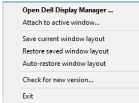
Se si seleziona **“Ripristino automaticamente del layout delle finestre”** (supporta sistema operativo Windows 10 o 8.1) le posizioni delle finestre dell'applicazione vengono rilevate e memorizzate da DDM. DDM porta automaticamente le finestre dell'applicazione nelle relative posizioni originali quando si ricollega il computer ai display.
