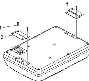
**3** Boor gaatjes voor  $\varnothing 3,6$  mm schroeven in een metalen deel van het voertuig en bevestig de luidsprekereenheid aan het voertuig met de zelftappende schroeven **6**.
