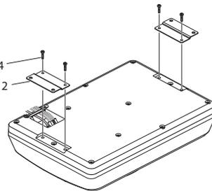
❸ Bohren Sie die Führungsbohrungen für die  $\varnothing 3,6$ -mm-Schrauben am Blechteil des Fahrzeugs und bringen die Lautsprechereinheit mit den Blechschrauben ⑥ an.
