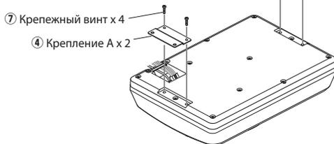
3 Просверлите направляющие отверстия для  $\varnothing 3,6$  мм винтов на участке листового металла автомобиля, и с помощью нарезного винта (6) прикрепите сабвуфер к автомобилю.
