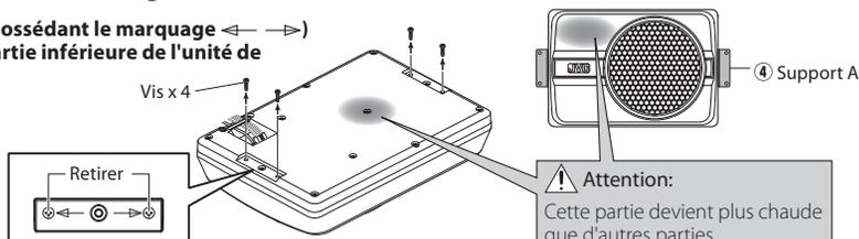
② Accrochez les supports A ④ à l'enceinte fermement à l'aide des vis à métaux ⑦. Faites attention de ne pas coincer les câbles raccordés entre le haut-parleur et les supports A ④.
