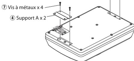
③ Percez des trous de 3,6 mm de diamètre dans le métal de la voiture et fixez le caisson au véhicule à l'aide de vis auto taraudeuses ⑥.
