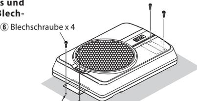
Bohren Sie vier Führungsbohrungen für Schrauben mit  $\varnothing 3,6$  mm.
