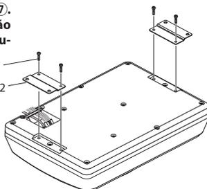
③ Perfure os orifícios guia para parafusos de  $\varnothing$  3,6 mm na secção da placa de metal do veículo e fixe a unidade do altifalante ao veículo utilizando os torneira parafusos ⑥.
