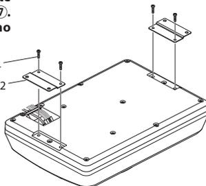
③ Praticare i fori pilota per le viti da  $\varnothing 3,6$  mm nella parete metallica del veicolo ed applicare il diffusore al veicolo utilizzando le viti filettanti ⑥.
