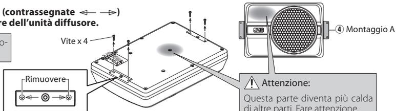
② Attaccate i montaggio A ④ sull'unità altoparlante in modo ben saldo usando le viti per macchina ⑦. Badare a che i cavi collegati non si frappongano fra il diffusore e i montaggio A ④.
