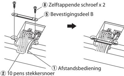
**1** Sluit de 10 pins stekkersnoer **2** en de afstandsbediening **1** aan op de luidsprekereenheid.
