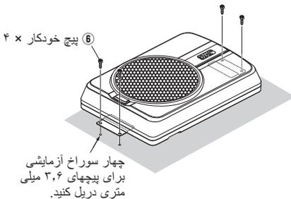
③ یک سوراخ آزمایشی برای پیچهای ۳,۶ میلی متری روی ورق فلزی خودرو دریل کنید و با استفاده از پیچ خودکار ⑥ دستگاه بلندگو را به وسیله نقلیه متصل نمایید.
