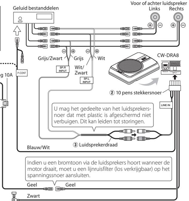
U mag het gedeelte van het luidsprekersnoer dat met plastic is afgeschermd niet verbuigen. Dit kan leiden tot storingen.
