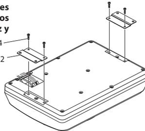
③ Taladre agujeros piloto para los tornillos de  $\varnothing 3,6$  mm en la sección de la hoja metálica del vehículo, y coloque el altavoz en el vehículo utilizando los tornillos de cubiertas ⑥.
