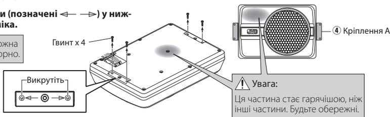
2 Під'єднайте кріплення А 4 до динаміка та надійно затягніть за допомогою кріпильних гвинтів 7. Будьте обережні, щоб під'єднані кабелі не попадали між динаміком та кріпленнями А 4.
