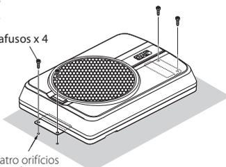
Perfure quatro orifícios guia para parafusos de  $\varnothing$  3,6 mm.
