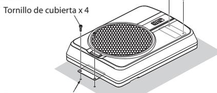
Taladre cuatro agujeros piloto para los tornillos de  $\varnothing 3,6$  mm.
