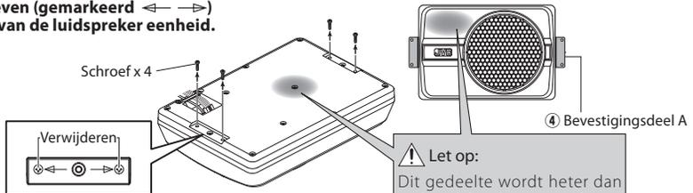
**2** Bevestig de Bevestigingsdeel A **4** aan de luidsprekereenheid veilig gebruik van de machineschroeven **7**. Wees voorzichtig, zodat de aangesloten kabels niet krijgen in de eenheid tussen de spreker en Bevestigingsdeel A **4**.
