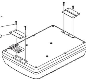
3 Висвердліть направляючі отвори для гвинтів  $\varnothing 3,6$  мм на ділянці листового металу автомобіля і під'єднайте блок динаміка до автомобіля за допомогою нарізний гвинт 6.
