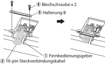
❶ 10-poligen Steckverbindungskabel ❷ und Fernbedienungsgeber ❶ an der Lautsprechereinheit anschließen.
