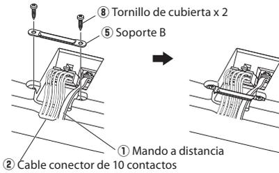
① Conecte el cable conector de 10 contactos ② y el mando a distancia ① a la unidad del altavoz.
