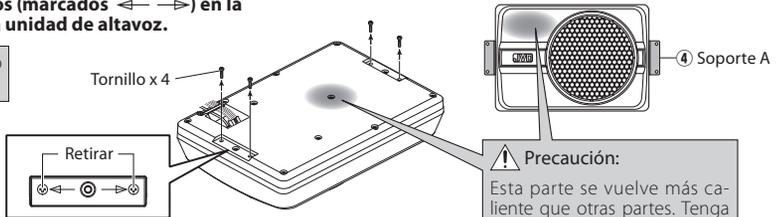
② Fije en forma segura los soportes A ④ a la unidad de altavoces utilizando los tornillos para metales ⑦. Tenga cuidado para que los cables conectados no queden atrapados entre la unidad de altavoz y los soportes A ④.
