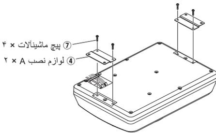
② لوازم نصب A ④ را به شکلی ایمن با استفاده از پیچ ماشینآلات ⑦ به دستگاه بلندگو متصل کنید. مراقب باشید تا کابلها متصل نشده بین دستگاه بلندگو و لوازم نصب A ④ قرار نگیرند.
