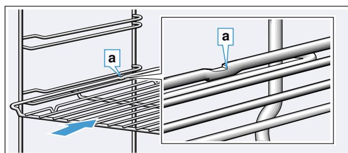
Durante l'inserimento dei pannelli, prestare attenzione che la tacca di arresto **a** sia nella parte posteriore e sia rivolta verso il basso. La smussatura dell'accessorio **b** deve essere rivolta in avanti verso la porta dell'apparecchio.
