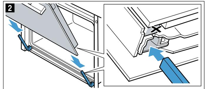
3. Aprire completamente la porta dell'apparecchio. Richiudere entrambe le leve di bloccaggio (figura 3).
