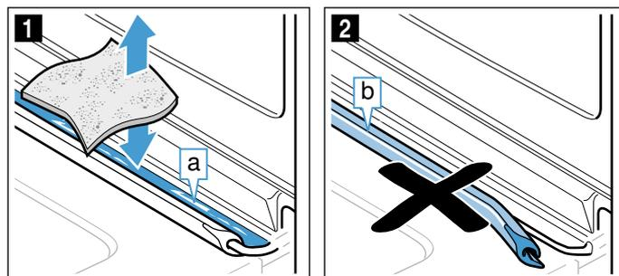
La canalina di scolo **a** si trova al di sotto del vano di cottura (figura **3**).
