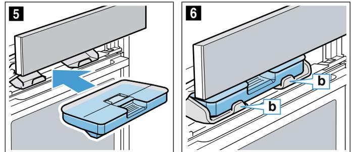
9. Spingere lentamente verso il basso il pannello, poi premerlo all'indietro, fino alla sua completa chiusura. Il serbatoio acqua è riempito. Ora è possibile avviare il funzionamento con il vapore.
