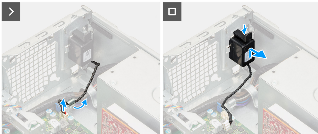
Figura 35. Rimozione degli altoparlanti
