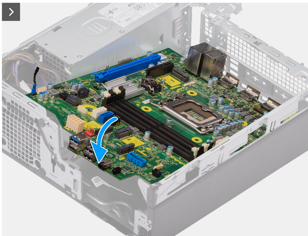
Figura 70. Installazione della scheda di sistema
