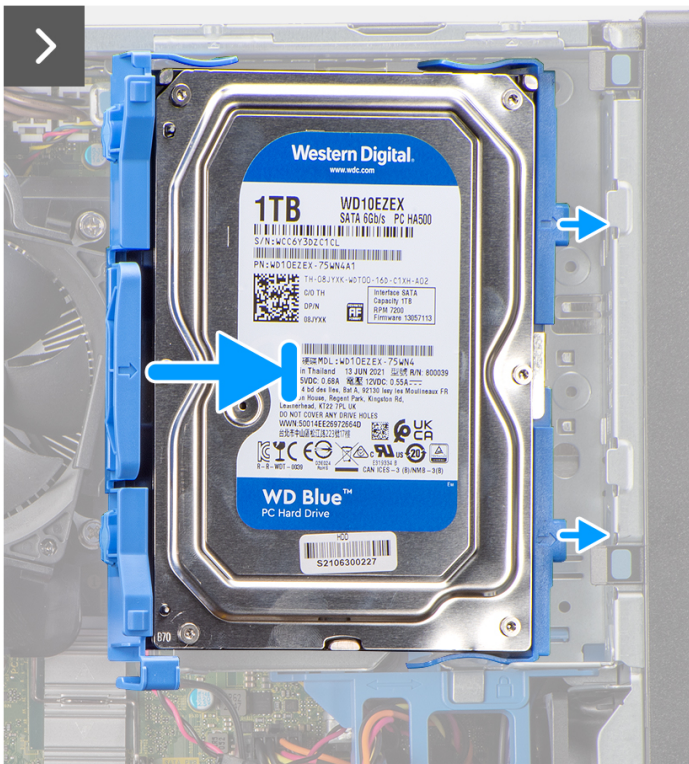
Figura 10. Installazione del disco rigido da 3,5 pollici
