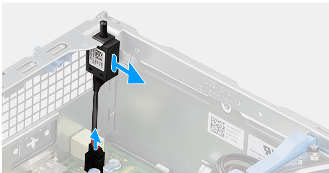
Figura 37. Rimozione dell'interruttore di intrusione
