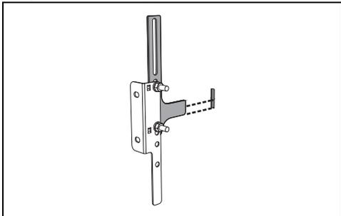
5. Allineare la base della staffa di fissaggio fino a terra e stringere le viti per fissare le misure.
