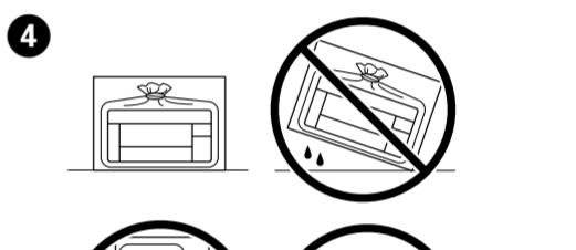
Darauf achten, dass die Tintenflasche beim Festziehen des Verschlusses aufrecht steht. Legen Sie den Drucker und die Flasche getrennt in einen Plastikbeutel und halten Sie den Drucker bei Lagerung und Transport waagerecht. Andernfalls könnte Tinte austreten.
