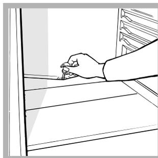
Le réfrigérateur est muni d'un système de dégivrage automatique : l'eau est acheminée vers la paroi arrière par un trou d'évacuation (voir figure) où la chaleur produite par le compresseur la fait évaporer. Il vous suffit de nettoyer périodiquement le trou d'évacuation pour
