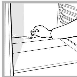
un apposito foro di scarico (*vedi figura*) dove il calore prodotto dal compressore la fa evaporare. L'unico intervento da fare periodicamente consiste nel pulire il foro di scarico affinché l'acqua possa defluire liberamente.
