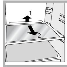
**BANDEJAS:** enteras o tipo rejilla. Son extraíbles y su altura es regulable gracias a las guías especiales (ver la figura), se utilizan para introducir recipientes o alimentos de gran tamaño. Para regular la altura no es necesario extraer
