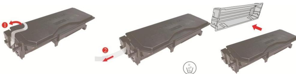
6. Inserire la cartuccia nel componente tamburo lungo il binario, per completare l'installazione della cartuccia.
