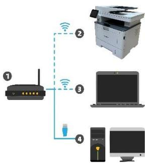
Modalità di struttura di base: collegare dispositivi wireless tramite il router collegamento
