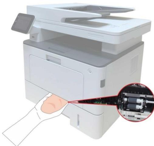
**Nota:** • Macchina con un alimentatore di documenti, ha bisogno di una pulizia regolare sporco alimentatore di documenti posizione di copertura, con panno di fronte morbido per pulire la posizione mostrata in figura.
