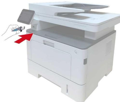
2. Una volta che la penna USB è inserita, l'interfaccia della penna USB apparirà automaticamente. Selezionare "Stampa USB".
