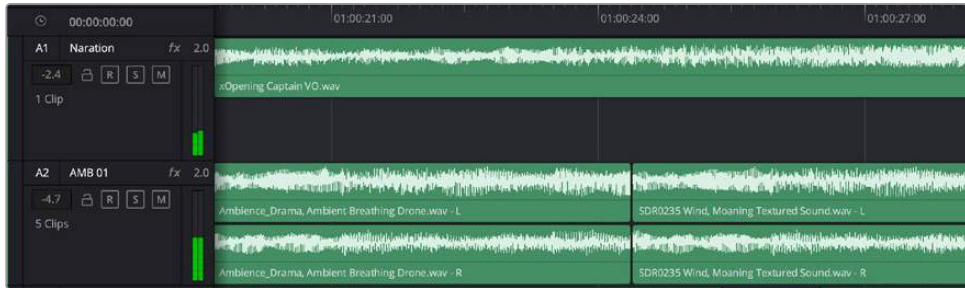
트랙 A1의 트랙 헤더에는 모노 오디오를 위한 단일 레인으로 구성된 모노 트랙이 나타나며, 트랙 A2 트랙 헤더에는 두 개 레인으로 구성된 스테레오 트랙이 나타납니다.
