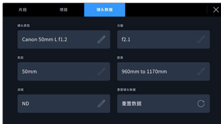
图中的“镜头数据”菜单显示的是从安装的镜头上自动输入的信息，以及手动输入的滤镜信息。
