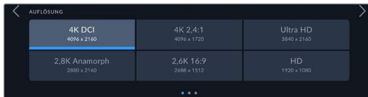
Auf der Pocket Cinema Camera 4K verfügbare Auflösungen. Für das 4K-DCI-Format heißt diese Kategorie „AUFLÖSUNG“, andernfalls „AUFLÖSUNG – SENSOR GECROPPPT“
