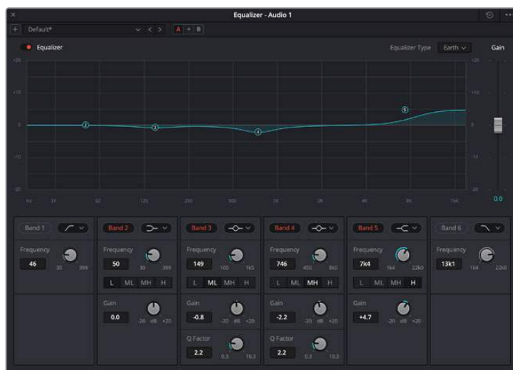
6バンドのパラメトリックイコライザー。トラック別に適用できます。
