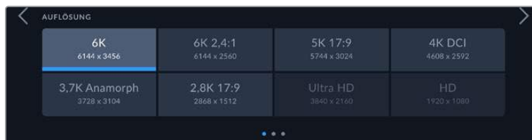
Auf der Pocket Cinema Camera 6K Pro und G2 6K verfügbare Auflösungen bei Verwendung des Blackmagic-RAW-Codex
