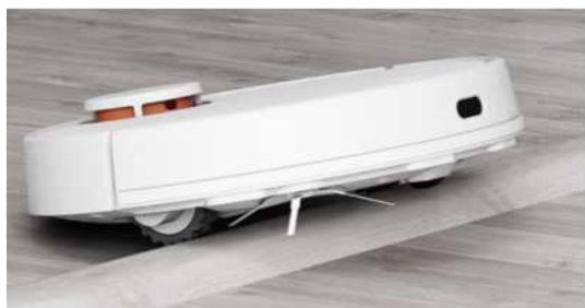
Superamento degli ostacoli fino ad un'altezza di 18mm
