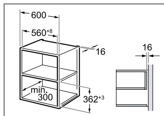
No montar el aparato a demasiada altura, a fin de poder retirar los accesorios sin problemas. Retirar los pies de apoyo.
