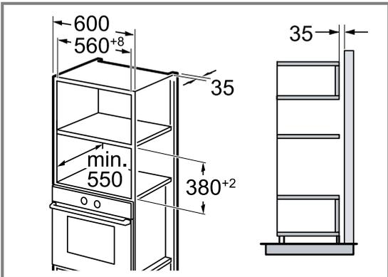
No montar el aparato a demasiada altura, a fin de poder retirar los accesorios sin problemas. Ajustar las patas de apoyo.
