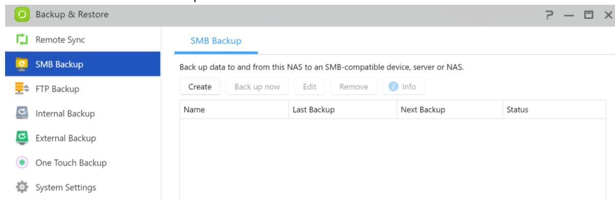
Quando si utilizza il backup SMB, assicurarsi che SMB sia abilitato sia sull'origine che sulla destinazione per garantire che i backup vengano completati correttamente. Fare riferimento a [Servizi] [SMB].
