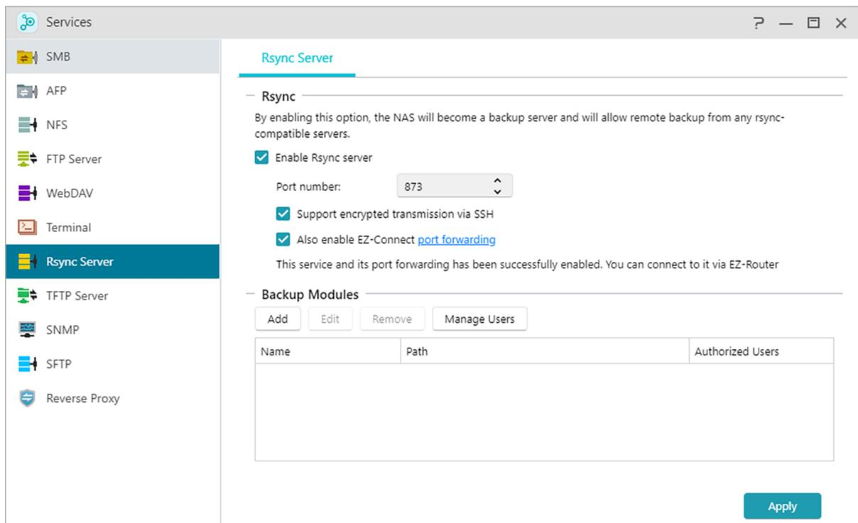
per consentire il back-up crittografato per i client, abilitare il supporto per la trasmissione crittografata tramite SSH. Abilitando questa funzione il sistema abilita automaticamente il servizio SSH (Terminale).
