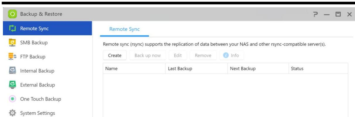
La funzione di sincronizzazione da remoto (Rsync) consente di utilizzare il NAS come destinazione od origine di back-up. Quando si utilizza il NAS come origine di back-up, è possibile eseguire il back-up dei dati dal NAS su un altro NAS di ASUSTOR remoto o su un server compatibile con Rsync. Quando si utilizza il NAS come destinazione di back-up, è possibile eseguire il back-up da un altro NAS di ASUSTOR remoto o da un server compatibile con Rsync sul NAS.
