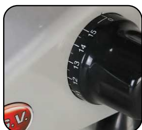
Manopola graduata per un taglio preciso. Graduated knob for a precise cutting.
