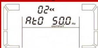
se in ingresso la frequenza è compresa tra 46Hz e 54Hz o 60Hz in uscita se in ingresso la frequenza è compresa tra 56Hz e 64Hz). Il dispositivo è automaticamente impostato in questa modalità.
