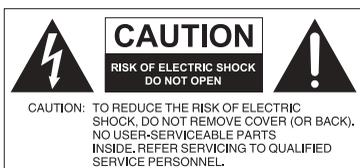
Il simbolo del fulmine con la punta a freccia all'interno di un triangolo equilatero, avvisa l'utente della presenza di tensioni pericolose non isolate all'interno del prodotto che possono essere di intensità sufficiente da costituire un rischio di folgorazione per le persone.
