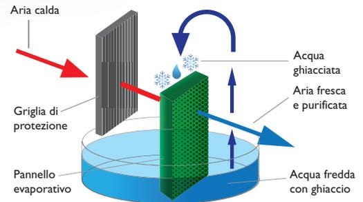
RAFFRESCATORE EVAPORATIVO SENZA PALE CON VENTILATORE CENTRIFUGO
