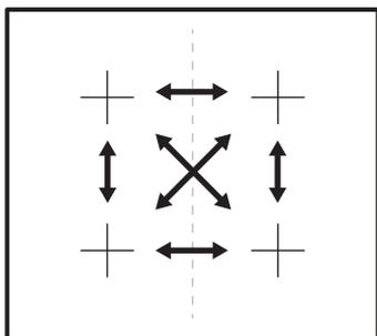
Quando si imposta la Limitazione potenza funzione **più di 6000 W**, la potenza del piano cottura è divisa tra le sezioni indicate di seguito.
