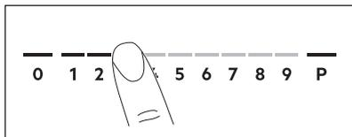
Premere il livello di calore desiderato sulla barra dei comandi. È inoltre possibile spostare il dito sulla barra dei comandi per impostare o modificare il livello di calore per una zona di cottura.
