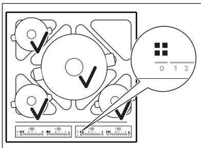
Per la combinazione sopra riportata, ci sono quattro barre di controllo attive. La pentola anteriore sinistra è indicata dalla spia A visibile sulla prima barra di controllo. La pentola posteriore sinistra è indicata dalla spia B sulla seconda barra di controllo. La pentola centrale è indicata dalle spie A B C D visibili sulla terza barra di controllo. La pentola anteriore destra è indicata dalla spia C visibile sulla quarta barra.
