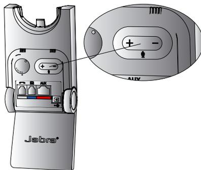
**Nota:** Per ripristinare il volume del microfono sull'impostazione predefinita, effettuare una chiamata e poi premere e tenere premuti entrambi i tasti +/- di regolazione del volume del microfono finché non viene emesso un segnale acustico, quindi rilasciarli.
