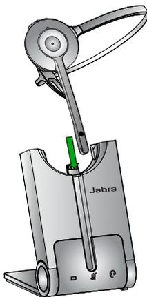
Inserire l'auricolare. Quando l'auricolare viene inserito correttamente, la batteria comincia a caricarsi (se necessario). Caricare per venti minuti oppure fino a quando l'indicatore della batteria sulla base
