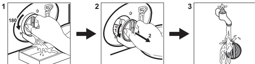
Pulire il filtro a intervalli regolati, e in particolare modo se il codice allarme **E20** viene visualizzato sul display.
