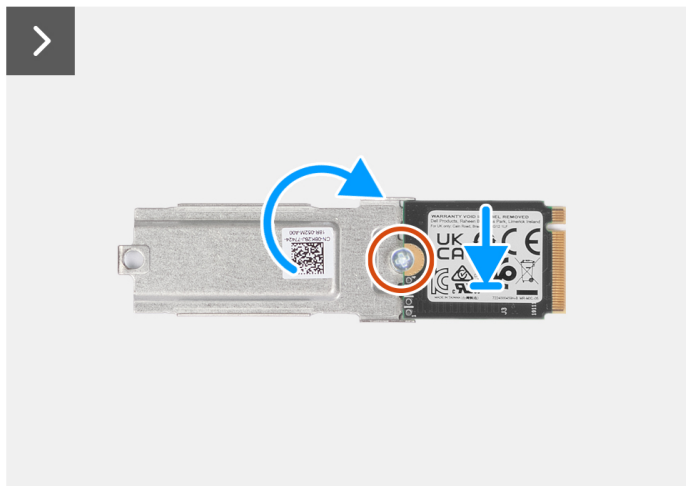
Figura 20. Installazione dell'unità SSD PCIe M.2 2230 (slot 1)
