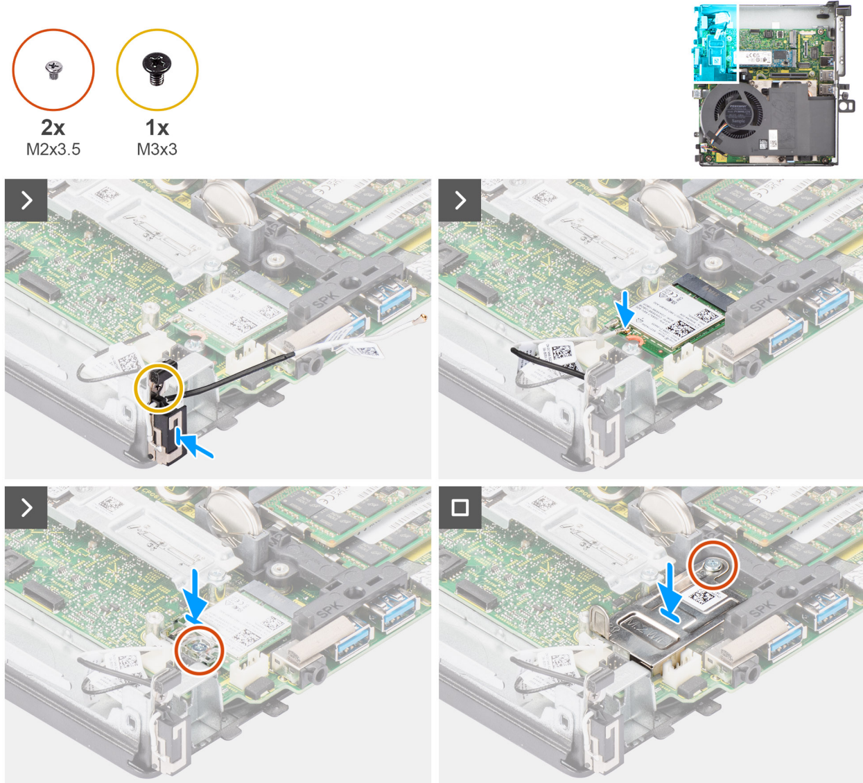
Figura 53. Installazione dell'antenna interna - Posizione 1
