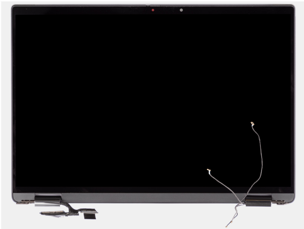
Figura 1. Gruppo del display con cavi dell'antenna WWAN
