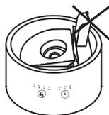
Non versare acqua nell'uscita dell'aria posta sulla base dell'umidificatore, potrebbe causare un malfunzionamento.
