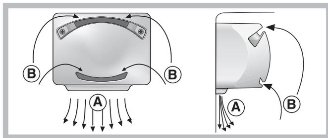
Wind Pure ottimizza al massimo la circolazione dell'aria, migliorando l'efficacia dell'evaporatore e contribuendo a raggiungere più rapidamente la giusta temperatura all'interno del frigo dopo ogni apertura.
