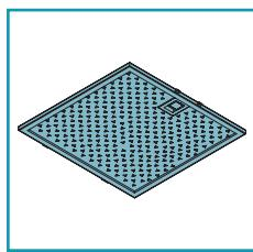
I filtri metallici antigrasso hanno la funzione di trattenere le particelle grasse in sospensione: queste ultime, depositate sui filtri, alimentano eventuali fiamme sprigionate durante la cottura, generano odori poco gradevoli e compromettono il passaggio dell'aria riducendo la capacità di aspirazione della cappa.
