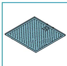
Os filtros metálicos antigordura têm a função de reter as partículas de gordura em suspensão: estas últimas, depositadas nos filtros, alimentam as eventuais chamas soltas durante o cozimento, gerando odores poucos agradáveis e comprometendo a passagem do ar e reduzindo a capacidade de aspiração da coifa.
