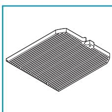
Aktiivihiilisuodattimien tehtävänä on pidättää niiden läpi virtaavan ilman hajuja: puhdistettu ilma palautetaan keittiöön suodattimien läpi menon jälkeen.
