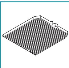
Les filtres au charbon actif ont pour fonction de retenir les odeurs présentes dans le flux d'air qui les traverse : l'air épuré par les passages successifs à travers les filtres est remis dans l'environnement cuisine.
