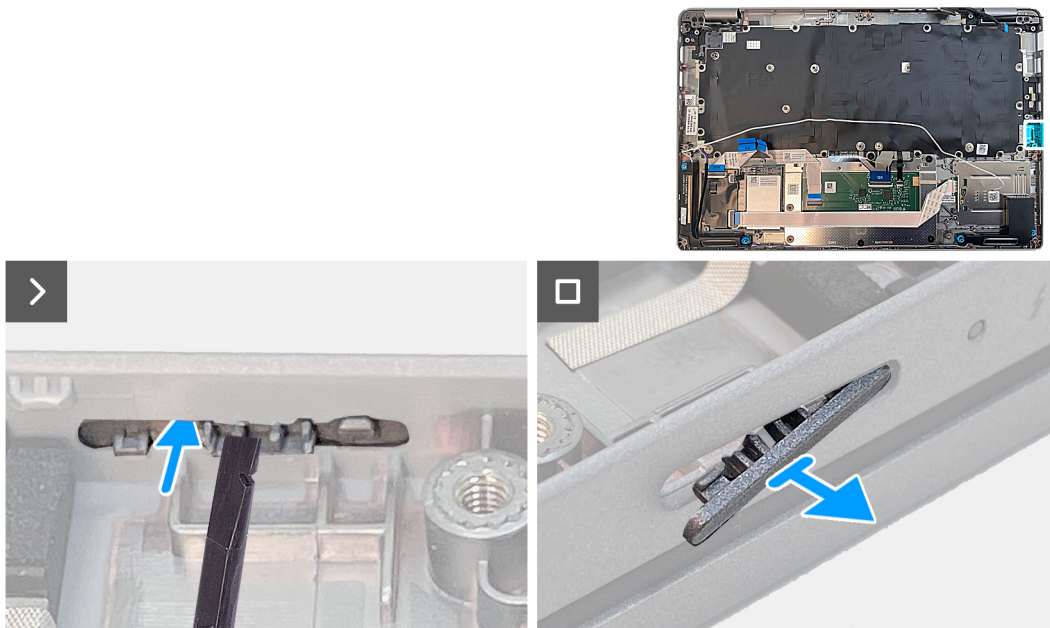
Figura 65. Rimozione del riempimento dello slot per schede SIM fittizie
