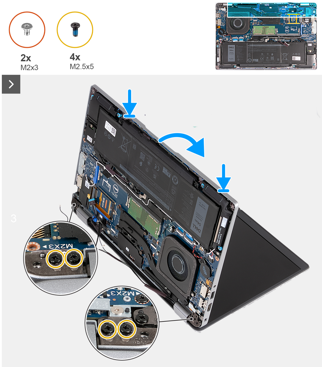
Figura 39. Installazione del gruppo del display - Per i computer forniti con scheda 5G
