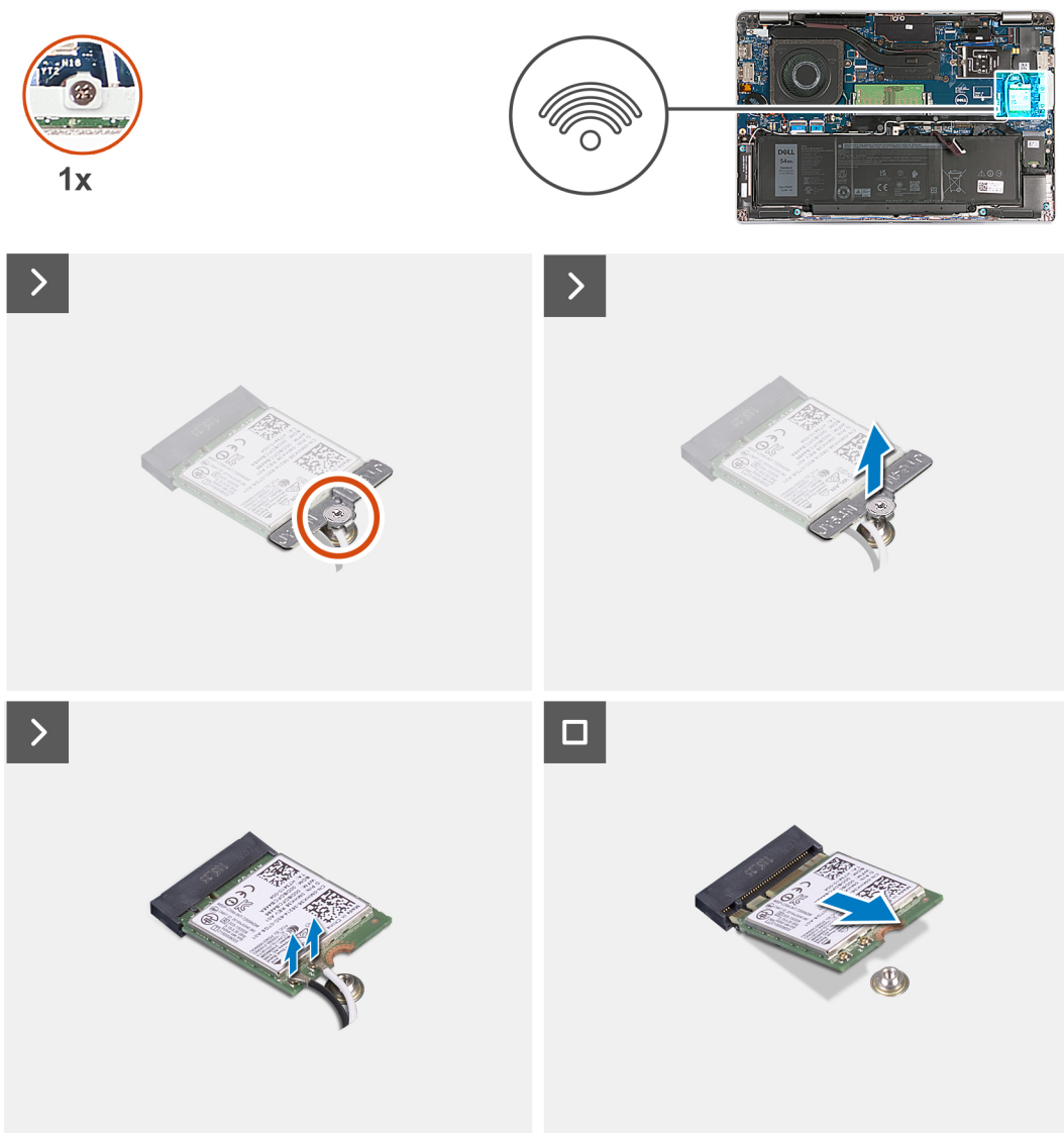
Figura 10. Rimozione della scheda wireless
