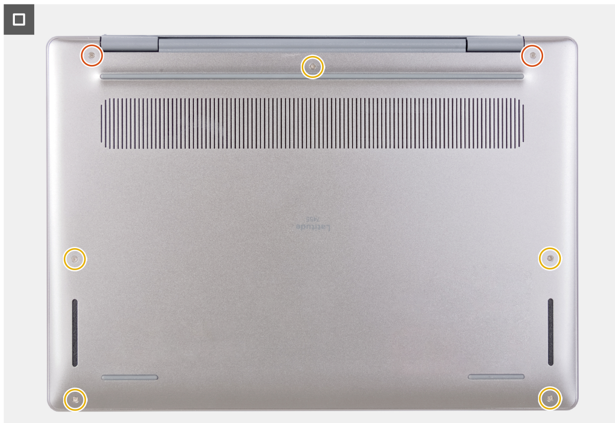
Figura 20. Serraggio e ricollocamento delle viti
