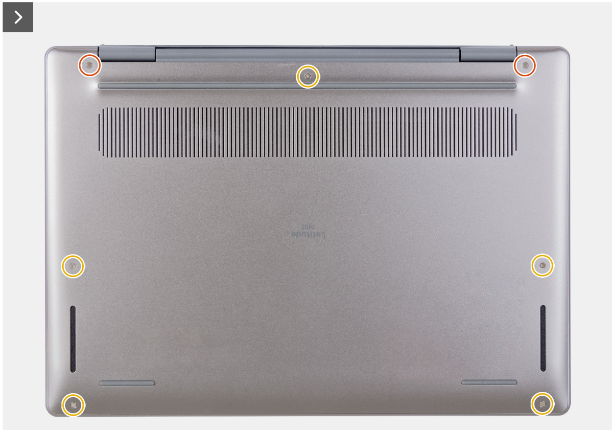
Figura 15. Rimozione del coperchio della base
