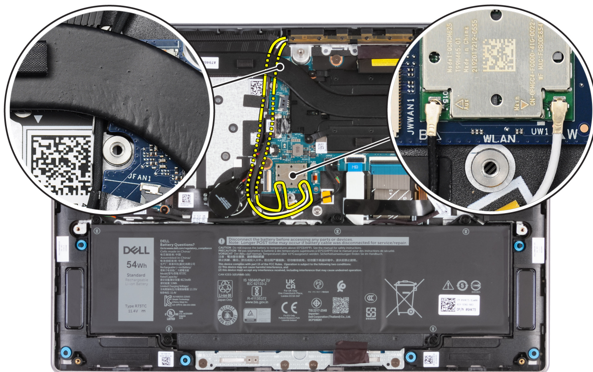
Figura 62. Installazione dei cavi dell'antenna WLAN
