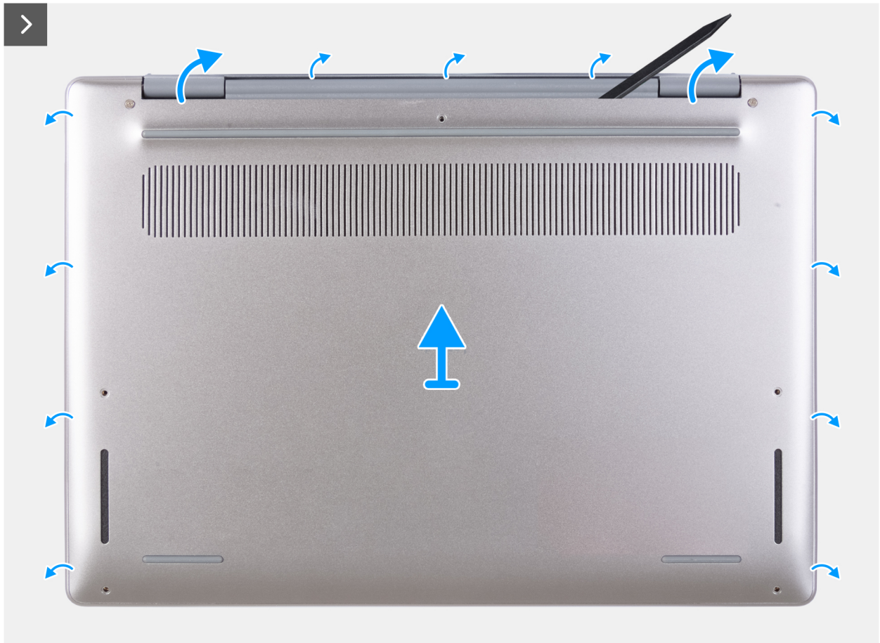
Figura 16. Rimozione del coperchio della base
