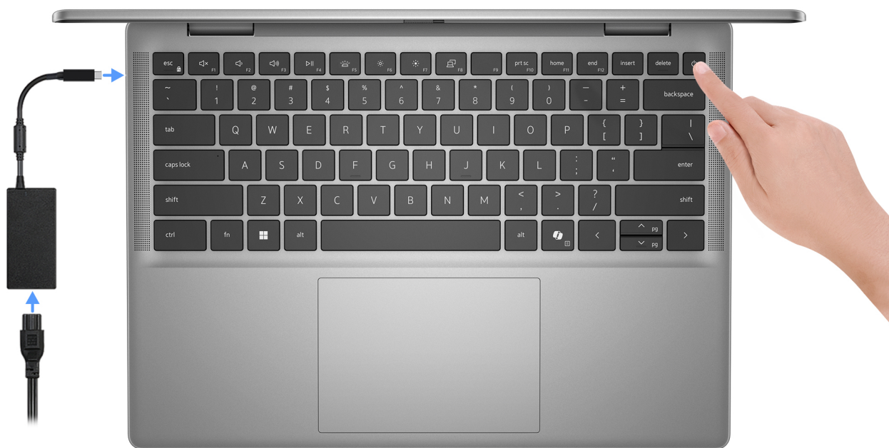
Figura 7. Collegare l'adattatore per l'alimentazione e premere il pulsante di accensione
