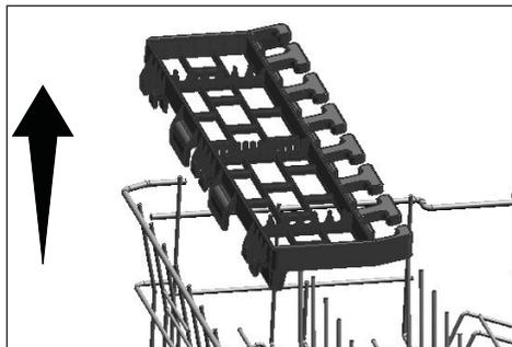
È possibile reinstallare il porta utensili multifunzionale del cestello superiore sul lato del cestello superiore per utilizzarlo di nuovo facilmente.
