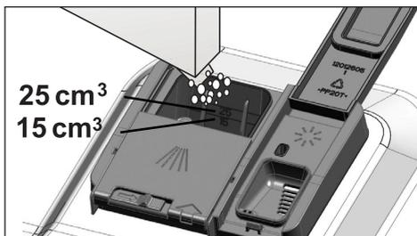
3. Spingere il coperchio dell'erogatore del detersivo per chiuderlo. Si sentirà un "clic" quando il coperchio viene chiuso.
