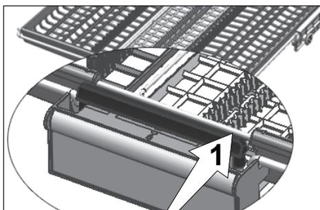
Nei modelli con funzionalità di movimento parziale, spingendo la sbarra (1) sulla maniglia diviene possibile portare alla posizione più bassa il vassoio centrale del cestello e il sistema si sblocca. In tale maniera, i vassoi laterali destro e sinistro possono essere utilizzati come parti mobili. Lo spazio libero che viene a crearsi con i vassoi laterali permette di caricare elementi lunghi sul cestello superiore.
