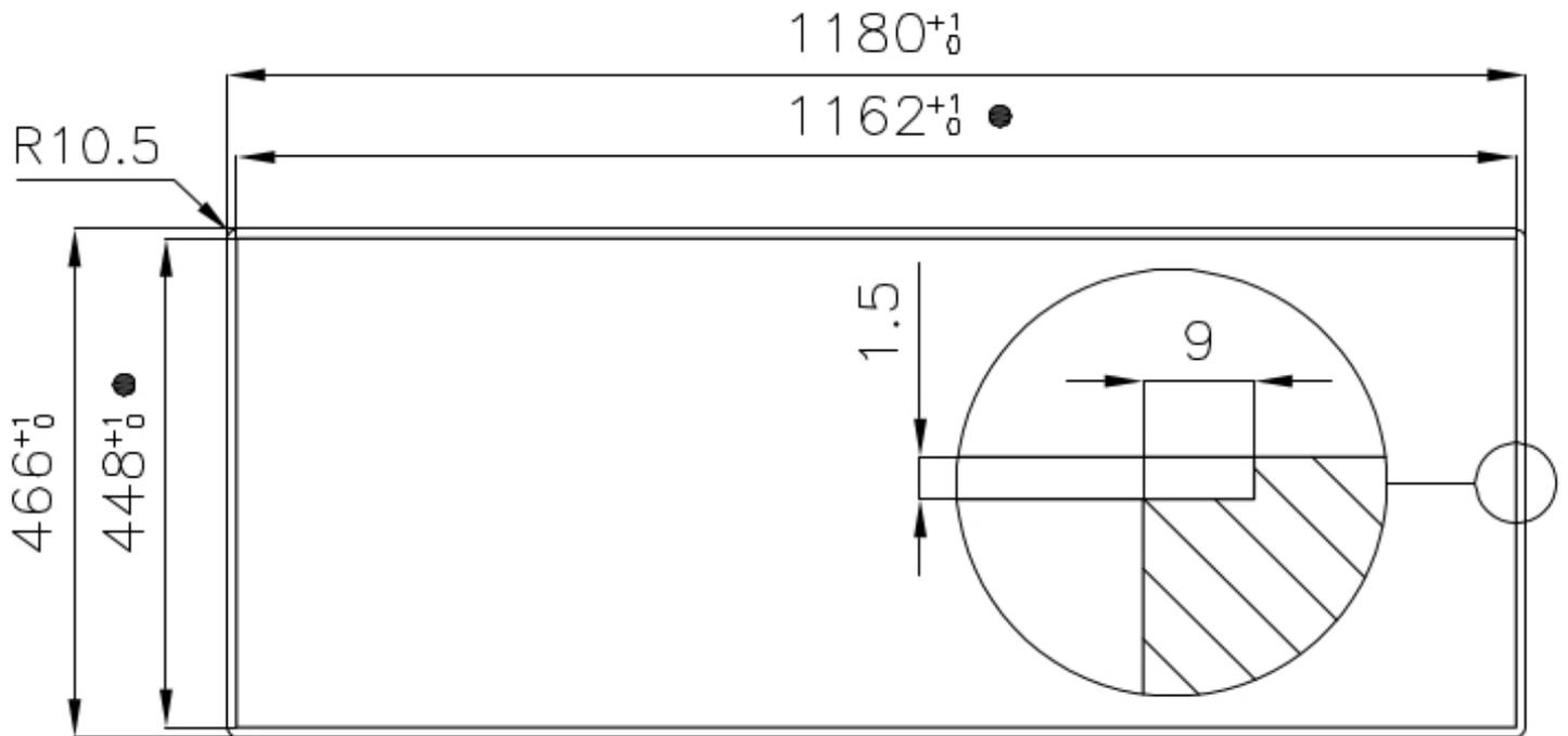
● Built-in cut out for FTS – Foratura per installazione FTS
