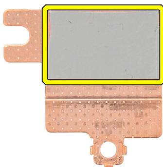
Figura 72. Cuscinetto termico sotto la protezione termica WLAN
