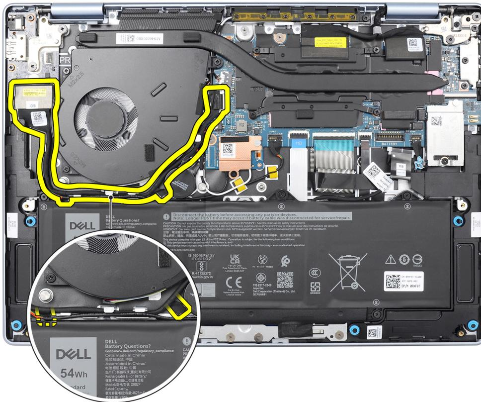
Figura 48. Posizione del cavo della scheda di I/O
