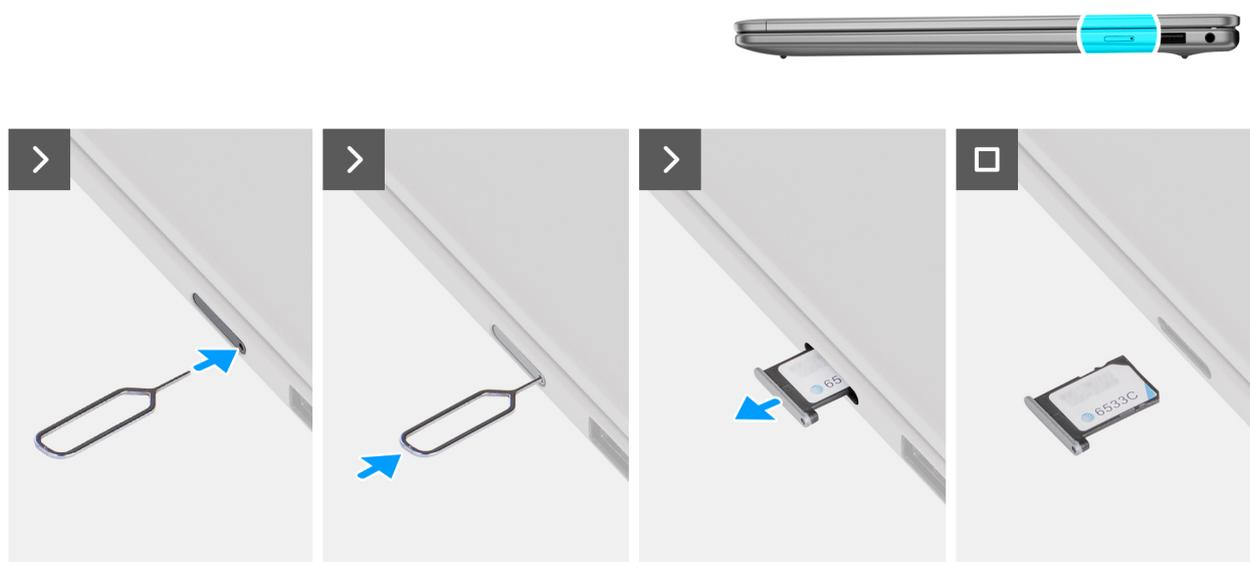
Figura 13. Rimozione del vassoio della scheda SIM
