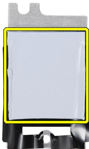
Figura 22. Cuscinetto termico sotto la protezione termica SSD
