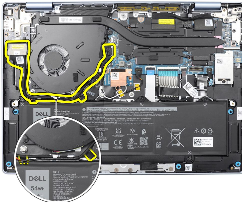
Figura 50. Posizione del cavo della scheda di I/O
