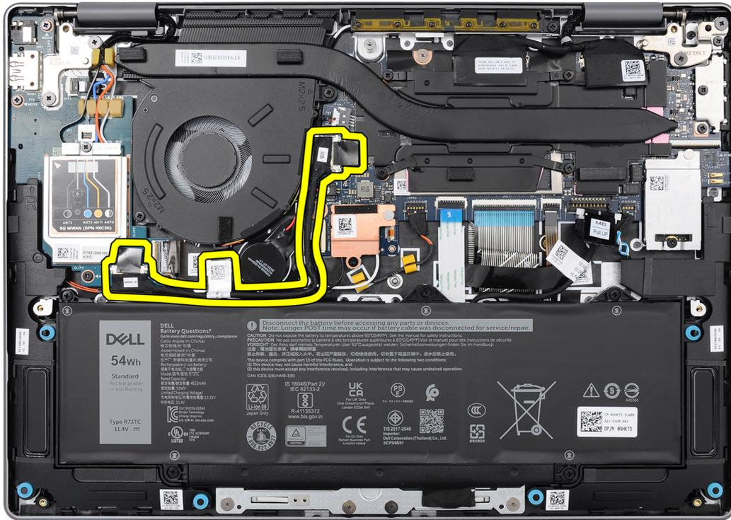
**Figura 52. Posizione del cavo della scheda di I/O**
