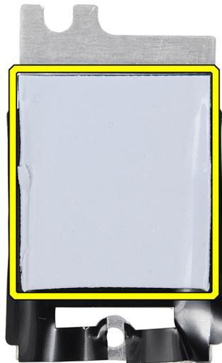
**Figura 25. Cuscinetto termico sotto la protezione termica SSD**
