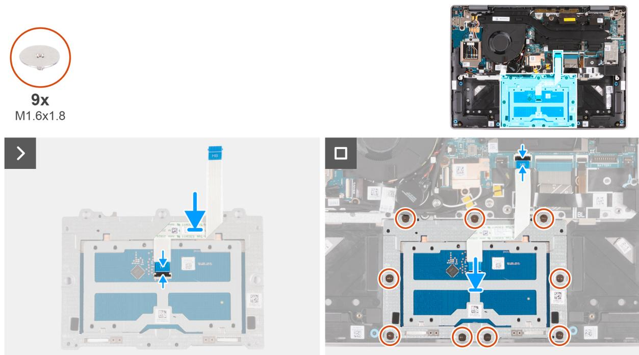
**Figura 87. Installazione del gruppo trackpad**
