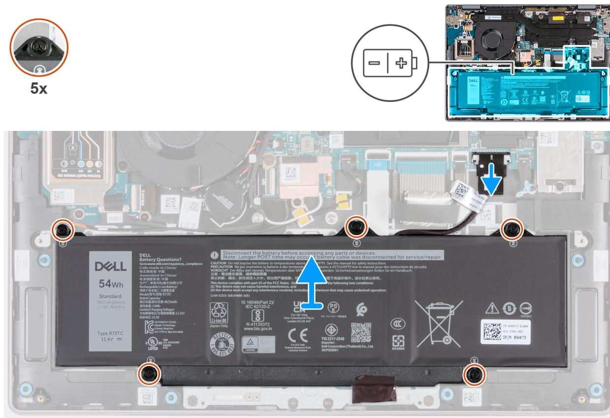
Figura 39. Rimozione della batteria
