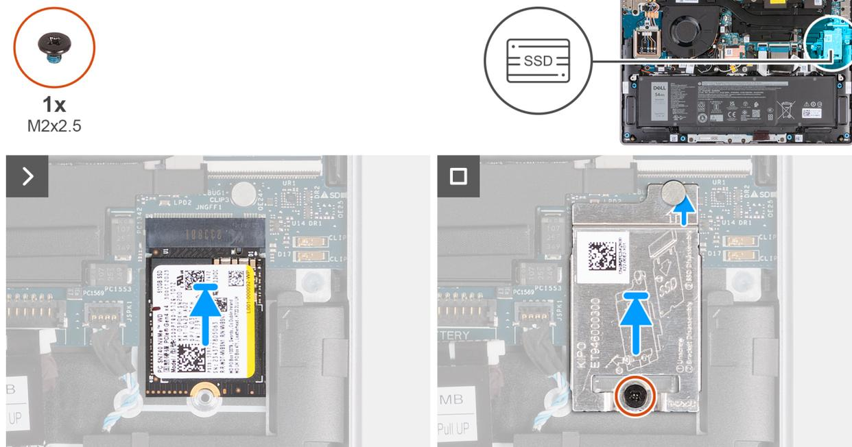
Figura 23. Installazione dell'SSD
