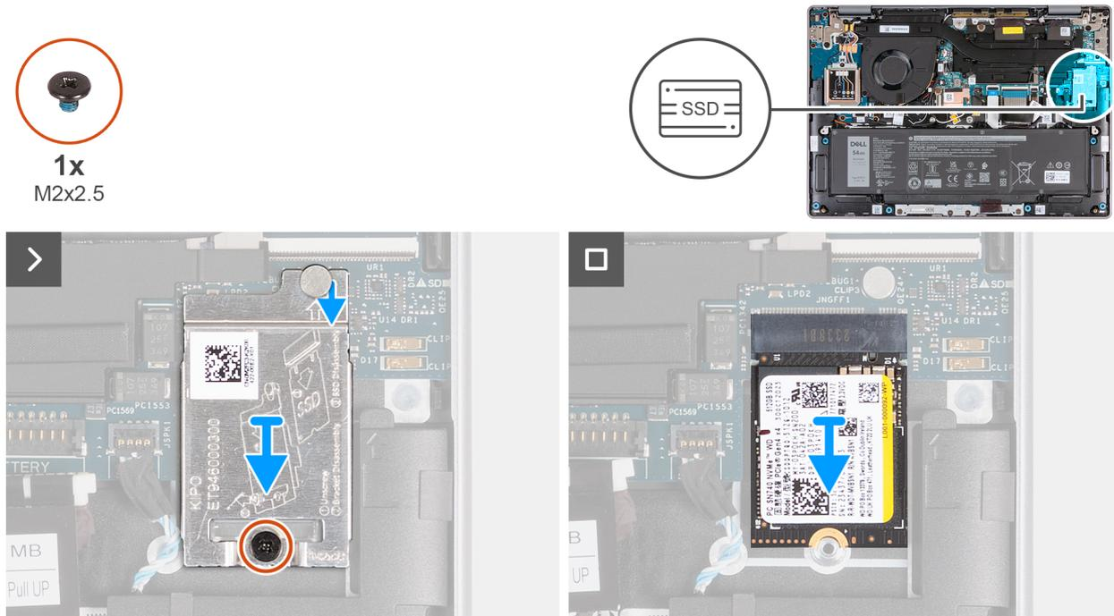
Figura 21. Rimozione dell'SSD
