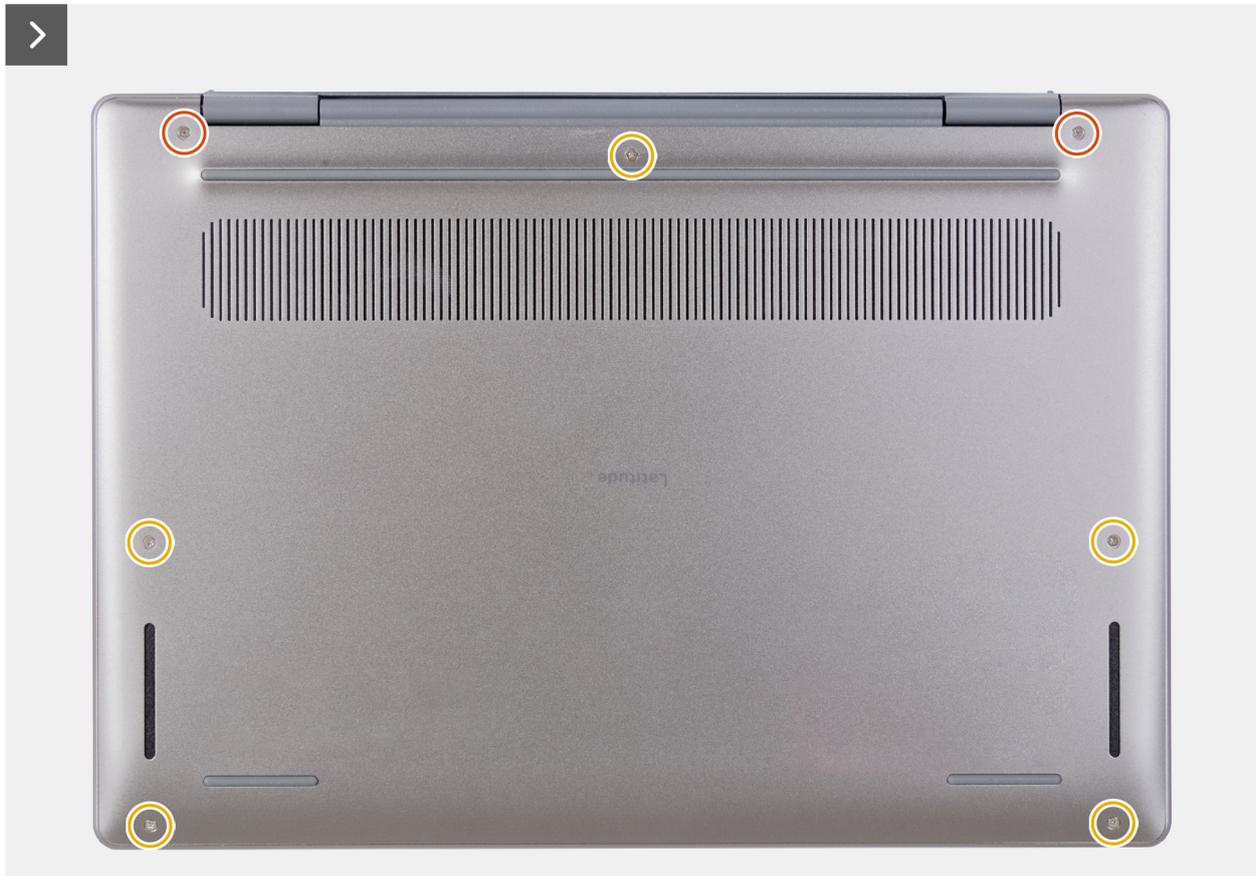
Figura 15. Rimozione del coperchio della base
