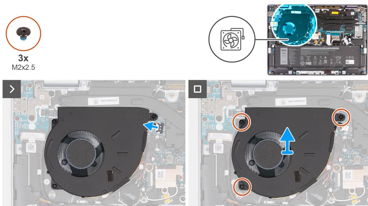
**Figura 35. Rimozione della ventola (per i computer forniti con supporto solo WLAN)**
