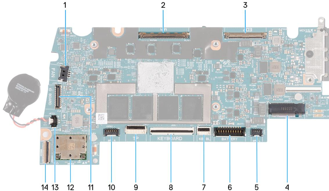
**Figura 97. Connettori della scheda di sistema**
