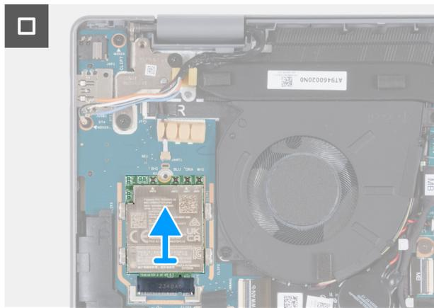
Figura 26. Rimozione della scheda WWAN 5G
