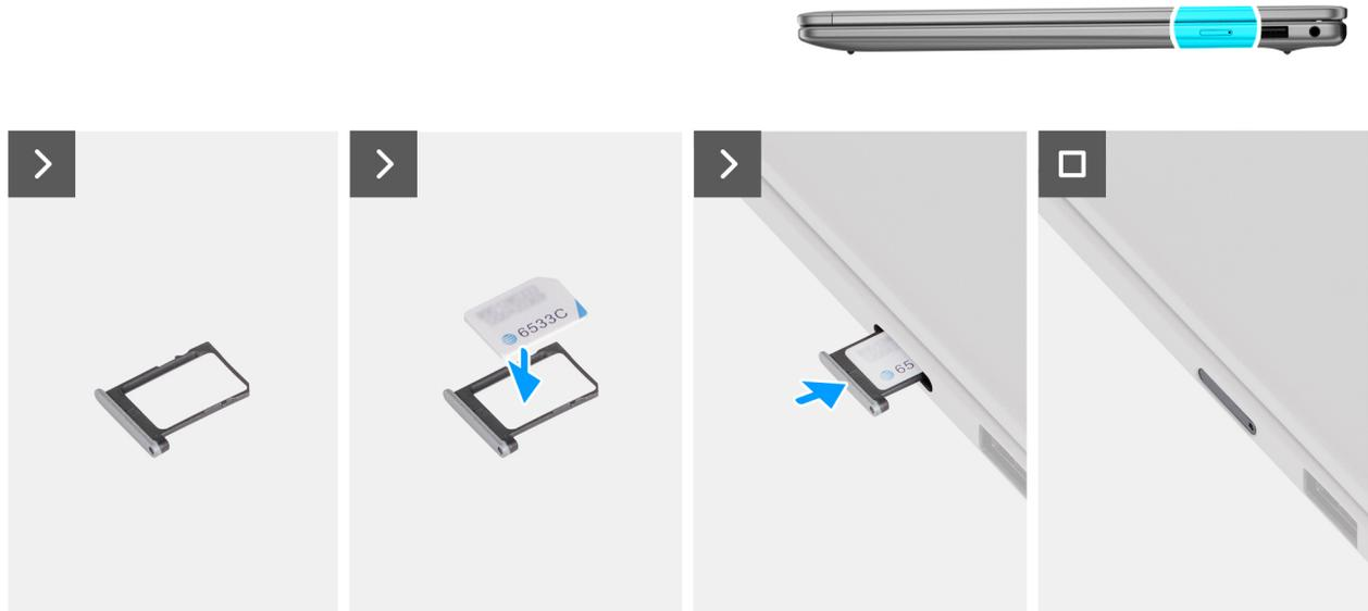
Figura 14. Installazione del vassoio per scheda SIM
