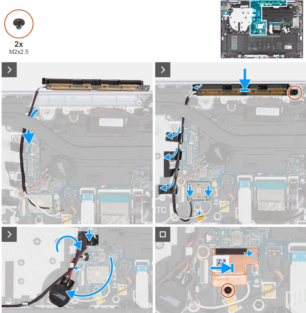
Figura 61. Installazione del modulo dell'antenna WLAN (per i computer forniti con supporto solo WLAN)
