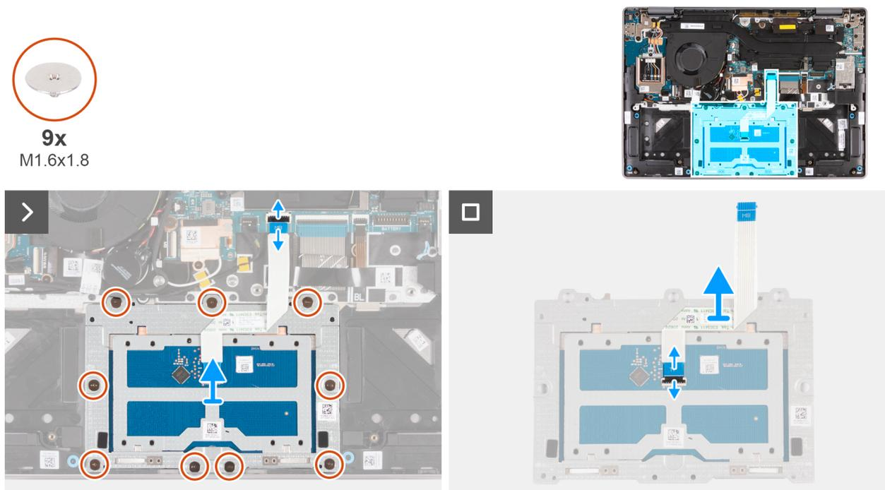
**Figura 86. Rimozione del gruppo trackpad**
