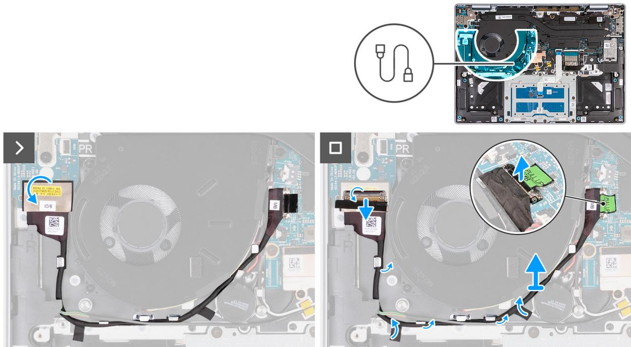
Figura 49. Rimozione del cavo della scheda di I/O (per i computer forniti con supporto solo WLAN)
