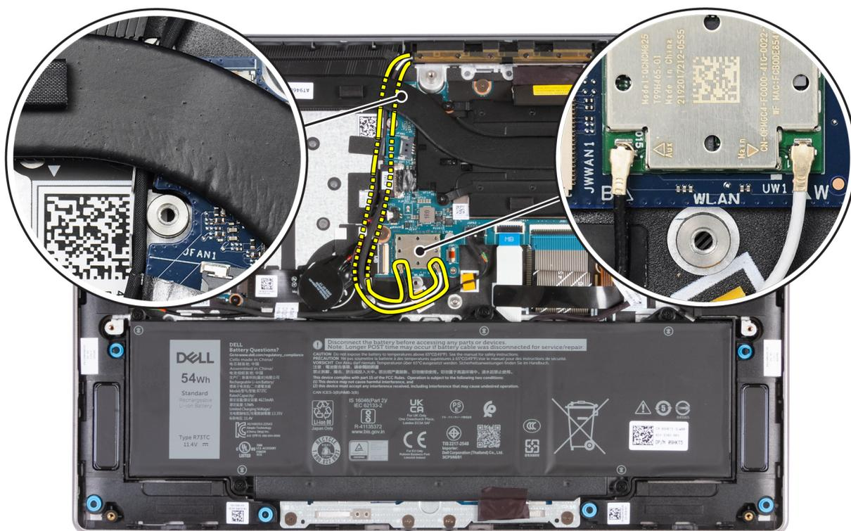
**Figura 71. Installazione dei cavi dell'antenna WLAN**
