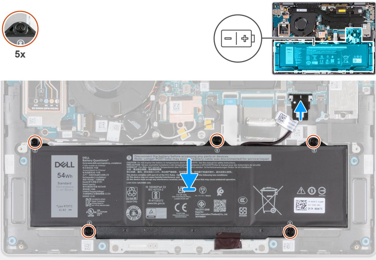
Figura 40. Installazione della batteria
