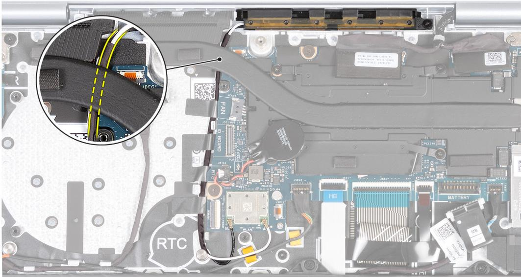
**Figura 68. Rimozione dei cavi dell'antenna WLAN**
