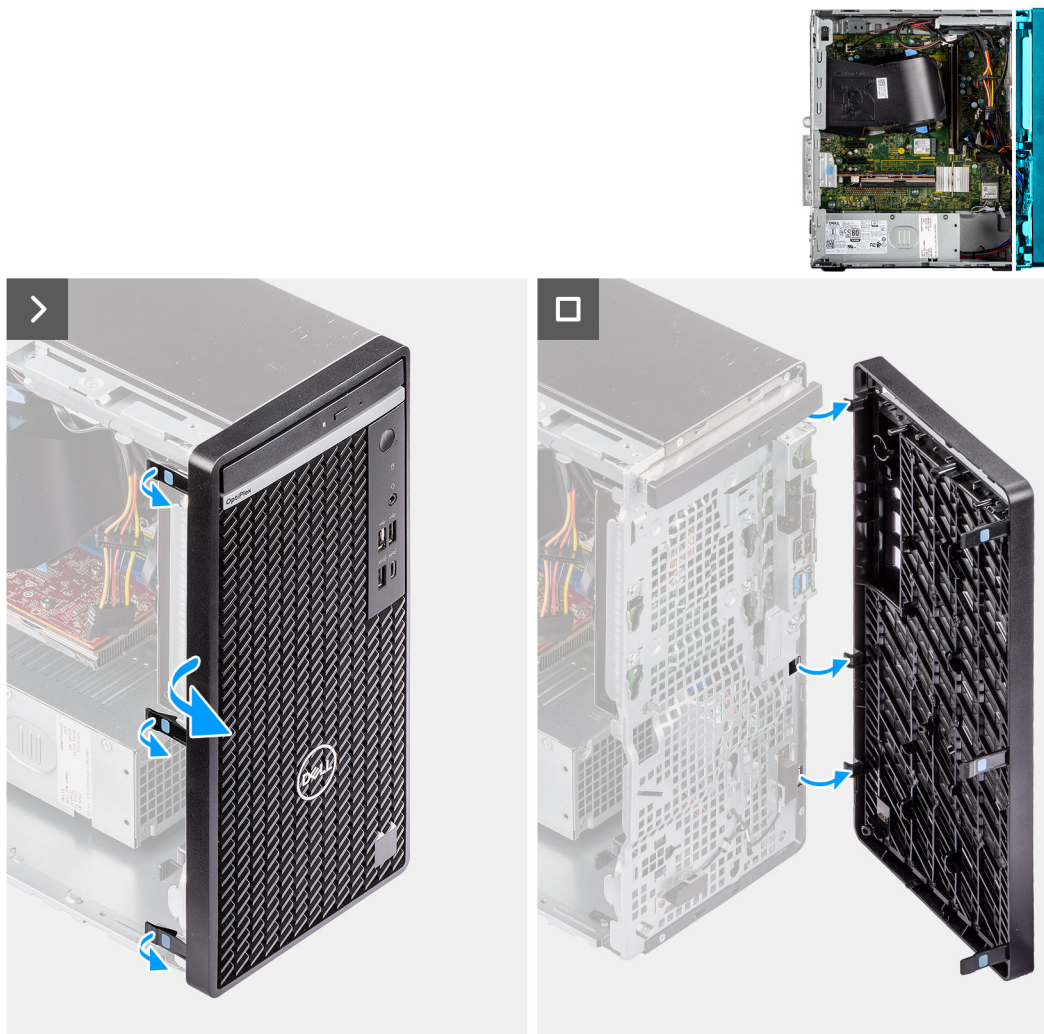
Figura 15. Rimozione del pannello anteriore
