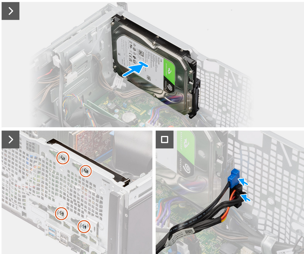
Figura 36. Installazione del disco rigido da 3,5 pollici
