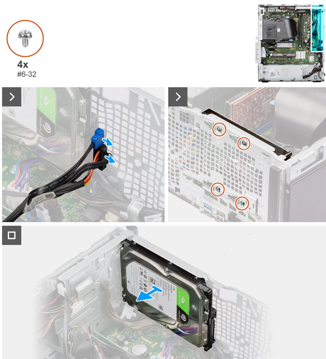
Figura 35. Rimozione del disco rigido da 3,5 pollici
