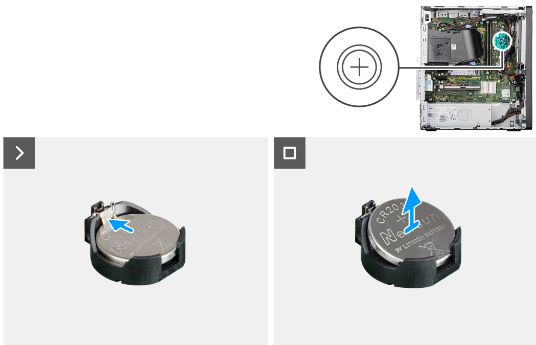
Figura 13. Rimozione della batteria a bottone
