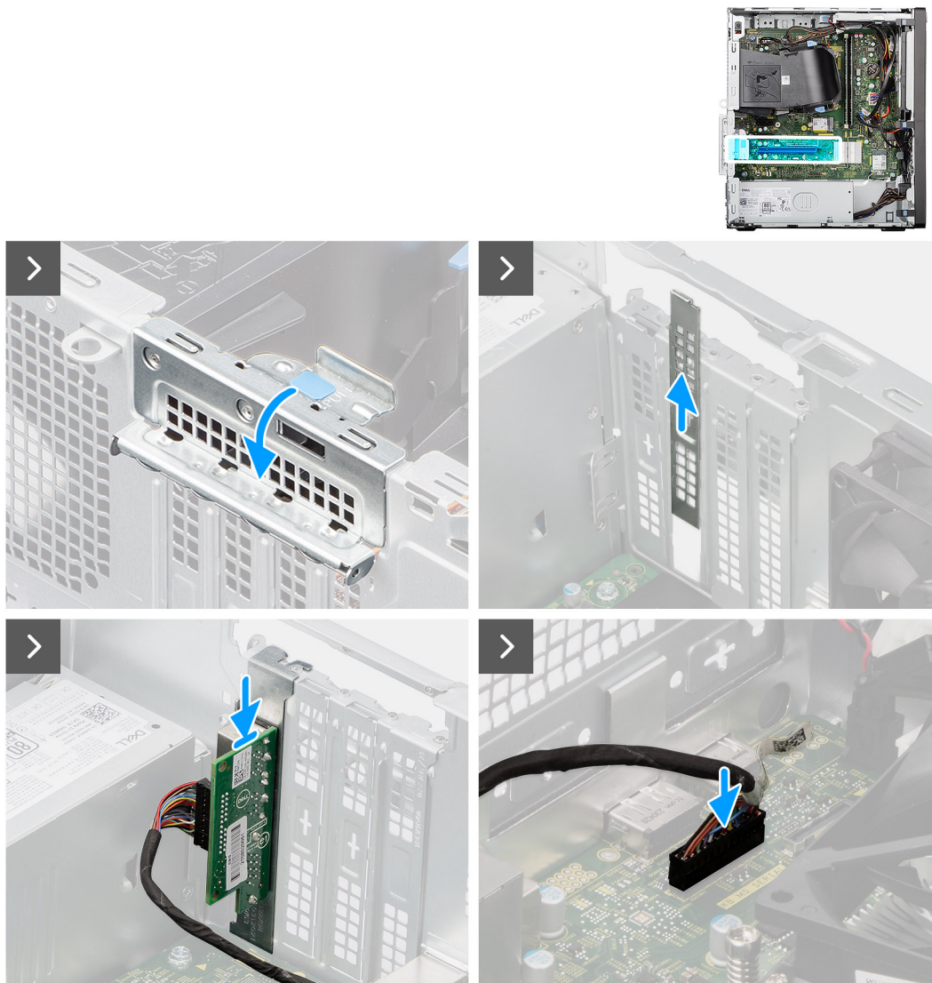
Figura 74. Installazione del modulo seriale e PS2 opzionale
