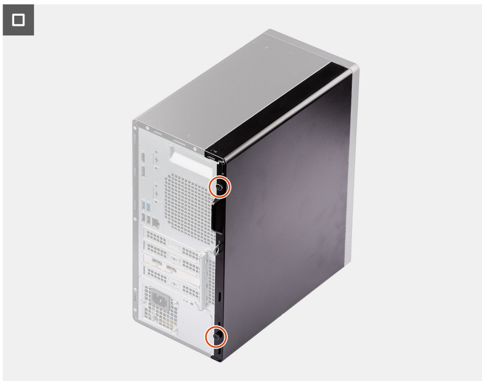
Figura 12. Installazione del coperchio laterale
