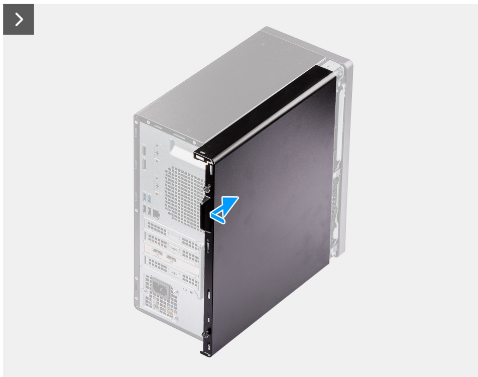
Figura 11. Installazione del coperchio laterale
