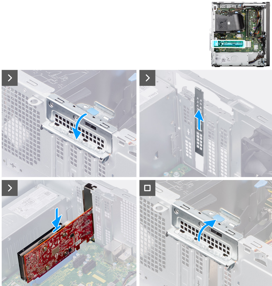
Figura 34. Installazione della scheda grafica
