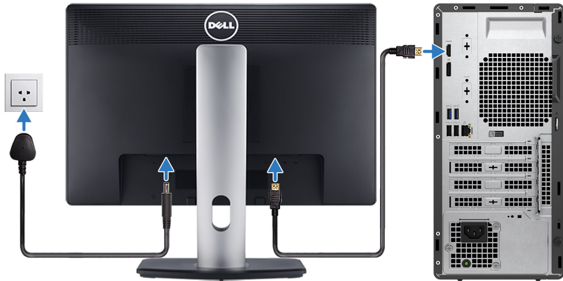
Figura 5. Connessione del display
