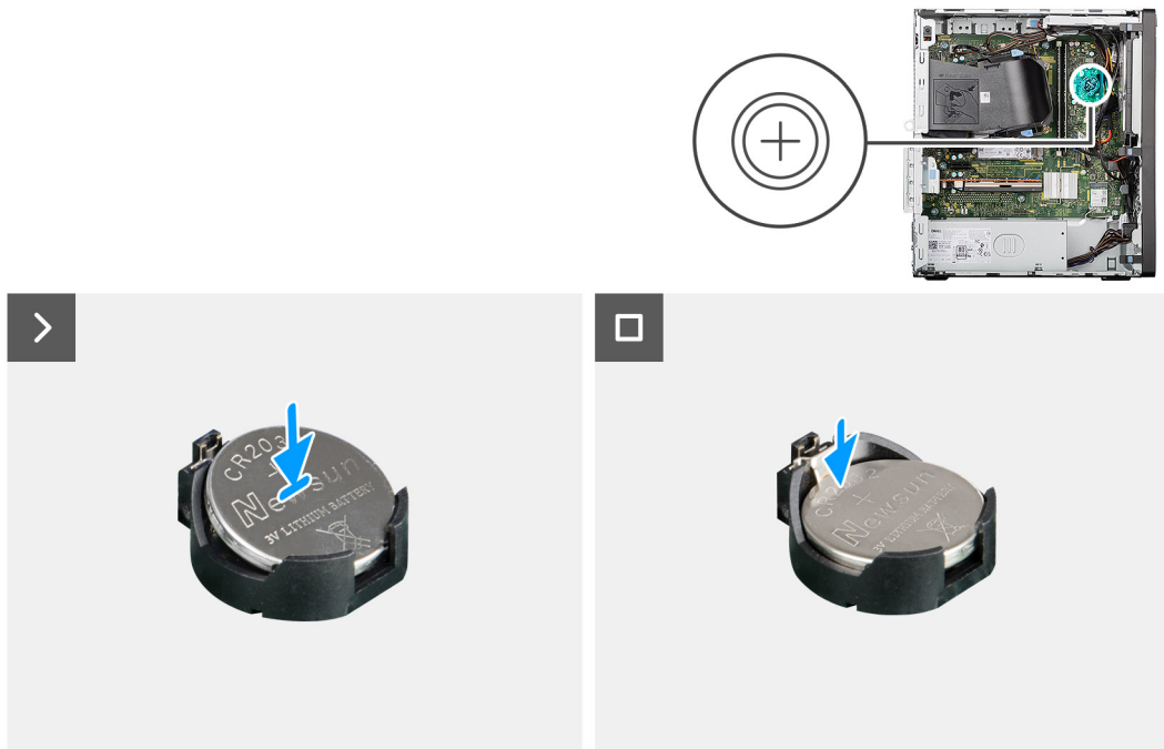
Figura 14. Installazione della batteria a bottone
