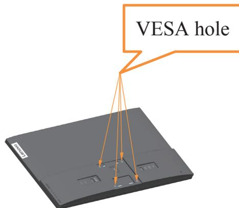
Fase 5: Installare lo schermo LCD sulla parete attenendosi alle istruzioni del kit per l'installazione su parete. Da usare solo con supporti per installazione su parete omologati UL con peso/carico minimo: 8kg
