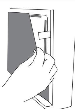
4. Inserire un nuovo filtro combinato. Per inserirlo in modo corretto, orientarsi con le linguette come mostrato in figura. Posizionare il pre-filtro.
