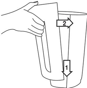
5. Setzen Sie die Gehäuseabdeckung wie abgebildet wieder ein, bis sie hör- und spürbar einrastet (Magnetverschluss). Hängen Sie den Magnetverschluss zuerst unten und anschließend oben ein.
