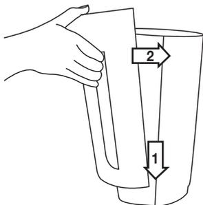
5. Ponownie nałożyć pokrywę obudowy, jak przedstawiono na rysunku, aż zablokuje się w sposób słyszalny i widoczny (zamknięcie magnetyczne). Zawiesić zamknięcie magnetyczne najpierw na górze, a następnie na dole.
