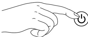
6. Enchufe el conector de red a la toma de corriente. Coloque el cable de forma que no se pueda tropezar con él. Mantenga pulsado el botón de ON/OFF (⏻) durante cinco segundos. El contador de horas de funcionamiento se ha vuelto a reponer a 0.
