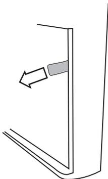
3. Извлеките фильтр грубой очистки. Затем осторожно оттяните боковые защелки, чтобы извлечь комбинированный фильтр.
