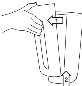
2. Retire la cubierta de la carcasa como se muestra en la imagen (cierre magnético). Desenganche el cierre magnético primero arriba y, a continuación, abajo.
