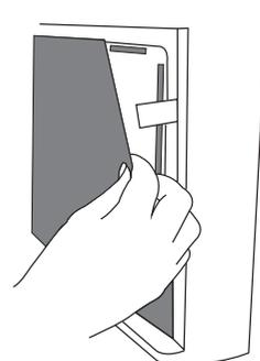
4. Setzen Sie einen neuen Kombifilter ein. Um den Kombifilter richtig einzusetzen, orientieren Sie sich an den seitlichen Laschen wie abgebildet. Platzieren Sie den Vorfilter darüber.
