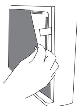
4. Insérez un nouveau filtre combiné. Pour insérer correctement le filtre combiné, orientez-vous vers les languettes comme indiqué. Placez le pré-filtre au-dessus.
