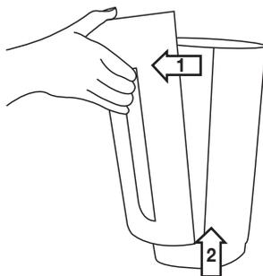
2. Снимите крышку корпуса, открыв замок на магните, как показано на иллюстрации. Потяните замок на магните сперва вверх, а затем вниз.
