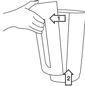
2. Cihaz kapađını řekilde gsterildiđi gibi karmn (mıknatıslı kilit). Mıknatıslı kilidi ncelikle stten ve sonra alttan ayırın.
