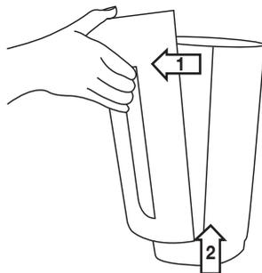
2. Retirez le couvercle du boîtier comme indiqué (fermeture magnétique). Accrochez d'abord la fermeture magnétique en haut, puis en bas.
