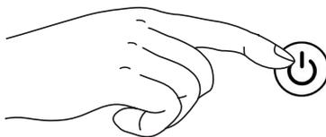
6. Вставьте сетевую вилку в розетку. Положите кабель так, чтобы об него нельзя было споткнуться. Нажмите кнопку ВКЛ./ВЫКЛ. (⏻) и удерживайте ее нажатой в течение пяти секунд. Счетчик часов работы сбросится до 0.
