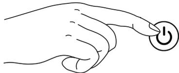
6. Stecken Sie den Netzstecker in die Steckdose. Verlegen Sie das Kabel stolpersicher. Halten Sie die EIN-/AUS-Taste (⏻) für fünf Sekunden gedrückt. Der Betriebsstundenzähler ist nun wieder auf 0 zurückgestellt.
