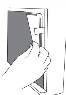
4. Coloque un nuevo filtro combinado. Para colocar el filtro combinado correctamente, guíese por las lengüetas, como se muestra en la imagen. Coloque el prefiltro encima.
