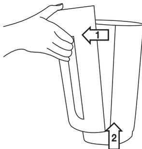
2. Zdjąć pokrywę obudowy jak przedstawiono na rysunku (zamknięcie magnetyczne). Wypiąć zamknięcie magnetyczne najpierw na górze, a następnie na dole.
