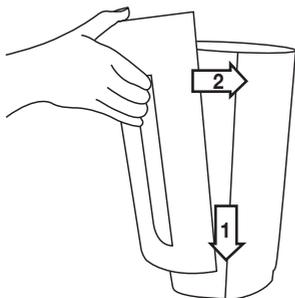
5. Remplacez le couvercle du boîtier comme indiqué jusqu'à encliquetage audible et sensible (fermeture magnétique). Accrochez d'abord la fermeture magnétique du bas, puis celle du haut.
