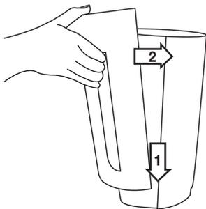
5. Закройте крышку корпуса до появления ощутимого и слышимого щелчка (замка на магните). Потяните замок на магните сперва вниз, а затем вверх.
