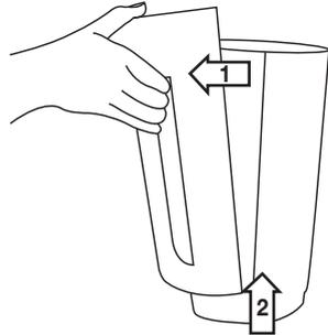
2. Nehmen Sie die Gehäuseabdeckung wie abgebildet ab (Magnetverschluss). Hängen Sie den Magnetverschluss zuerst oben und anschließend unten aus.
