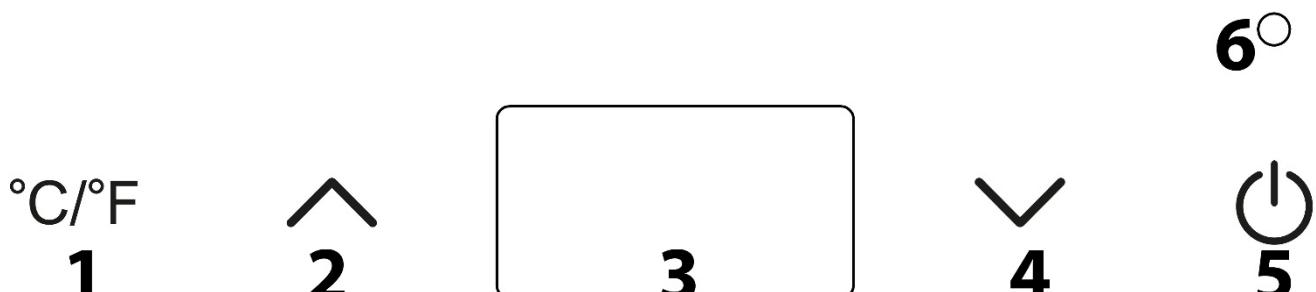
1 Comutación entre °C y °F, así como indicación de la temperatura actual en el interior del enfriador para botellas de vino
