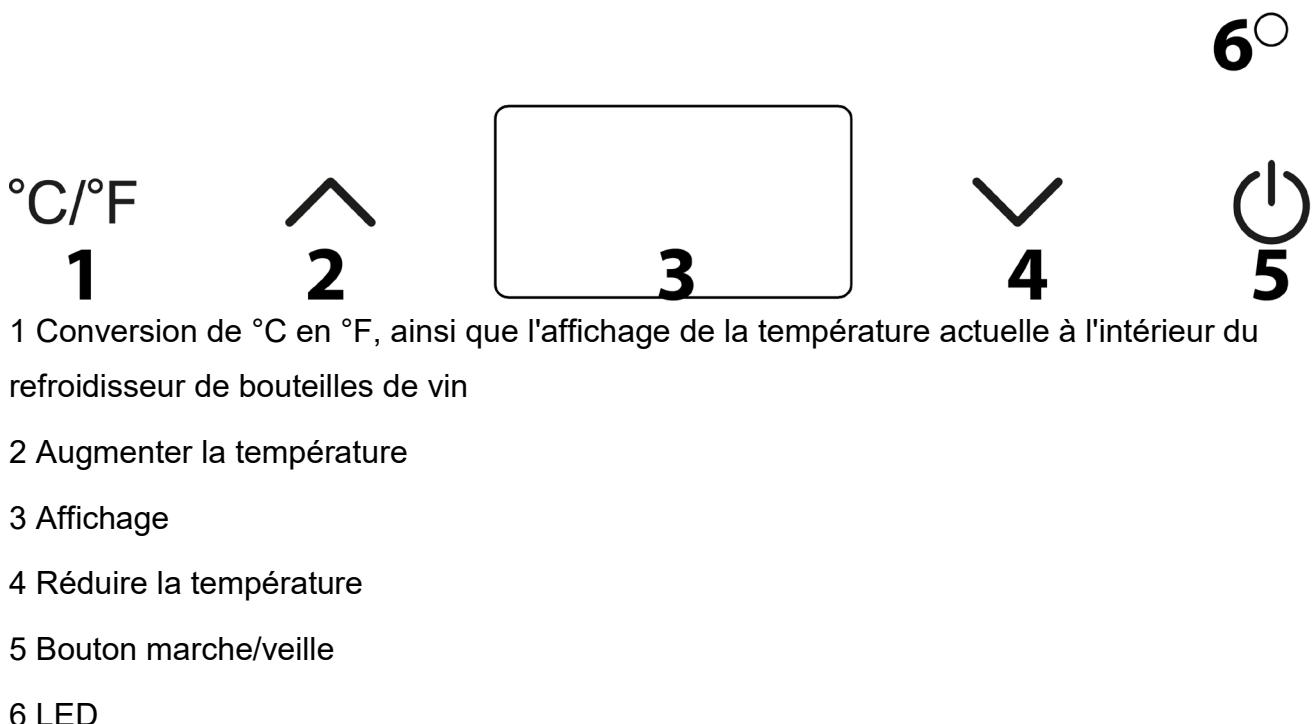
1 Conversion de °C en °F, ainsi que l'affichage de la température actuelle à l'intérieur du refroidisseur de bouteilles de vin
