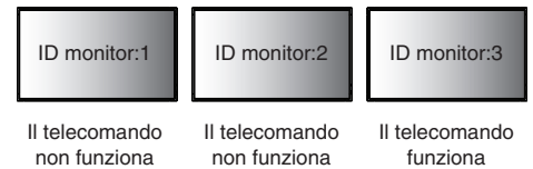
Figura 2 Telecomando impostato per utilizzare ID REMOTO:3
