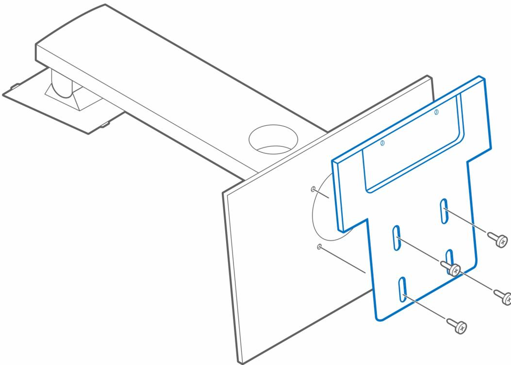
4. Posizionare il montaggio VESA per supporto per monitor Dell sul sistema.
