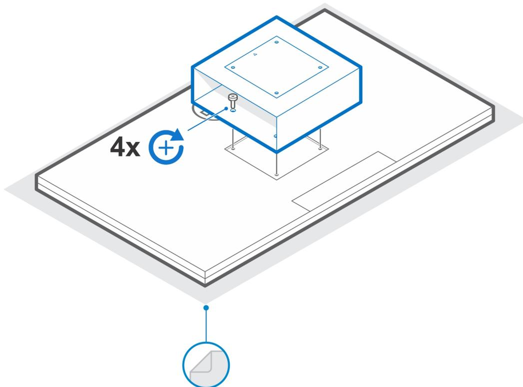
5. Far scorrere il sistema nel montaggio a manicotto VESA allineando i fori delle viti sul montaggio con quelli sul sistema.
