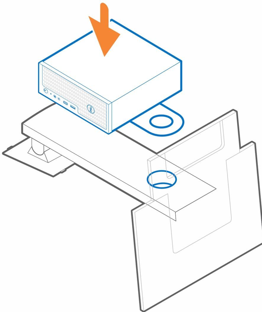
7. Installare il socket [1] dal lato del monitor nello slot di gestione dei cavi.
