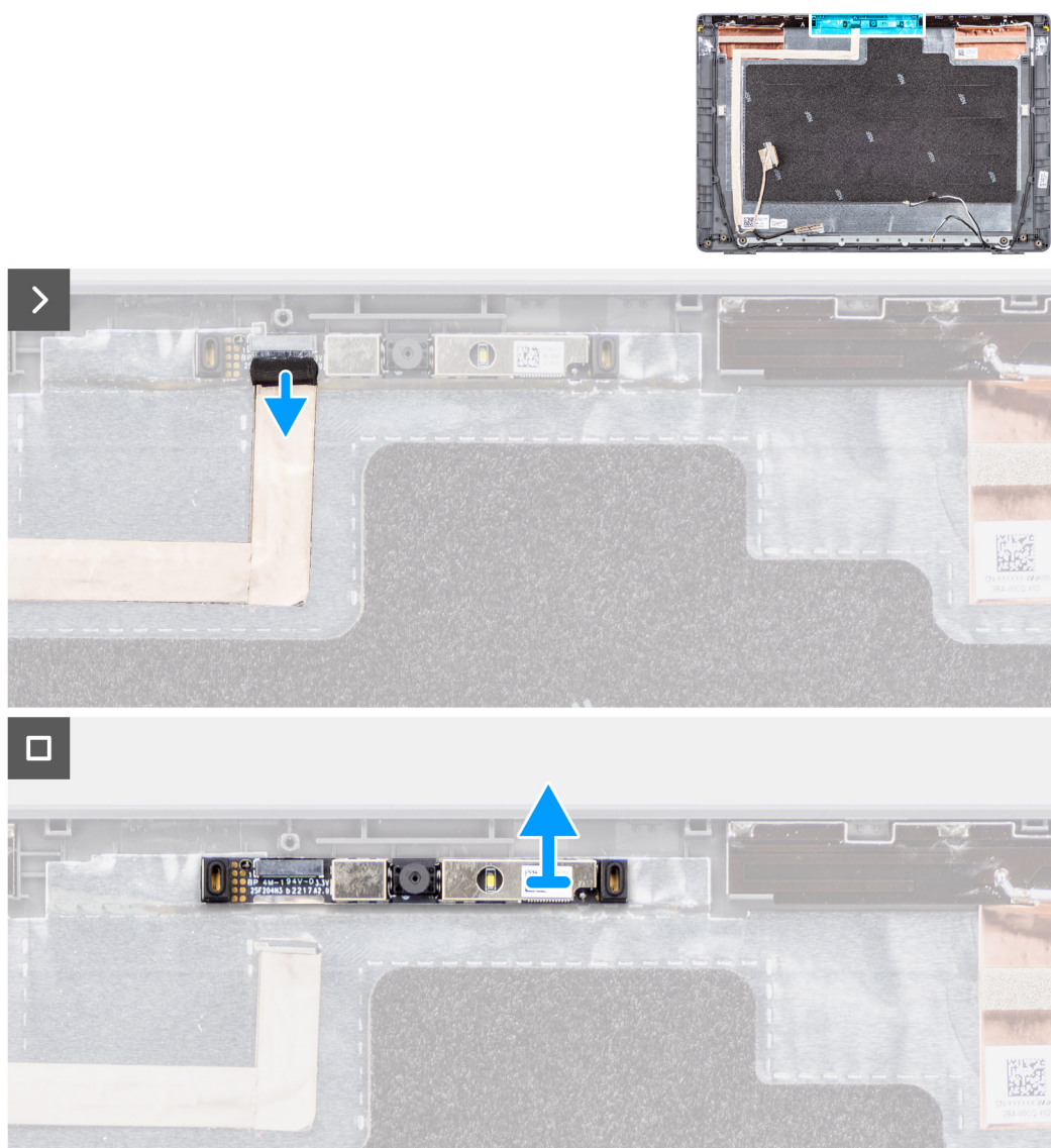
Figura 64. Rimozione della fotocamera
