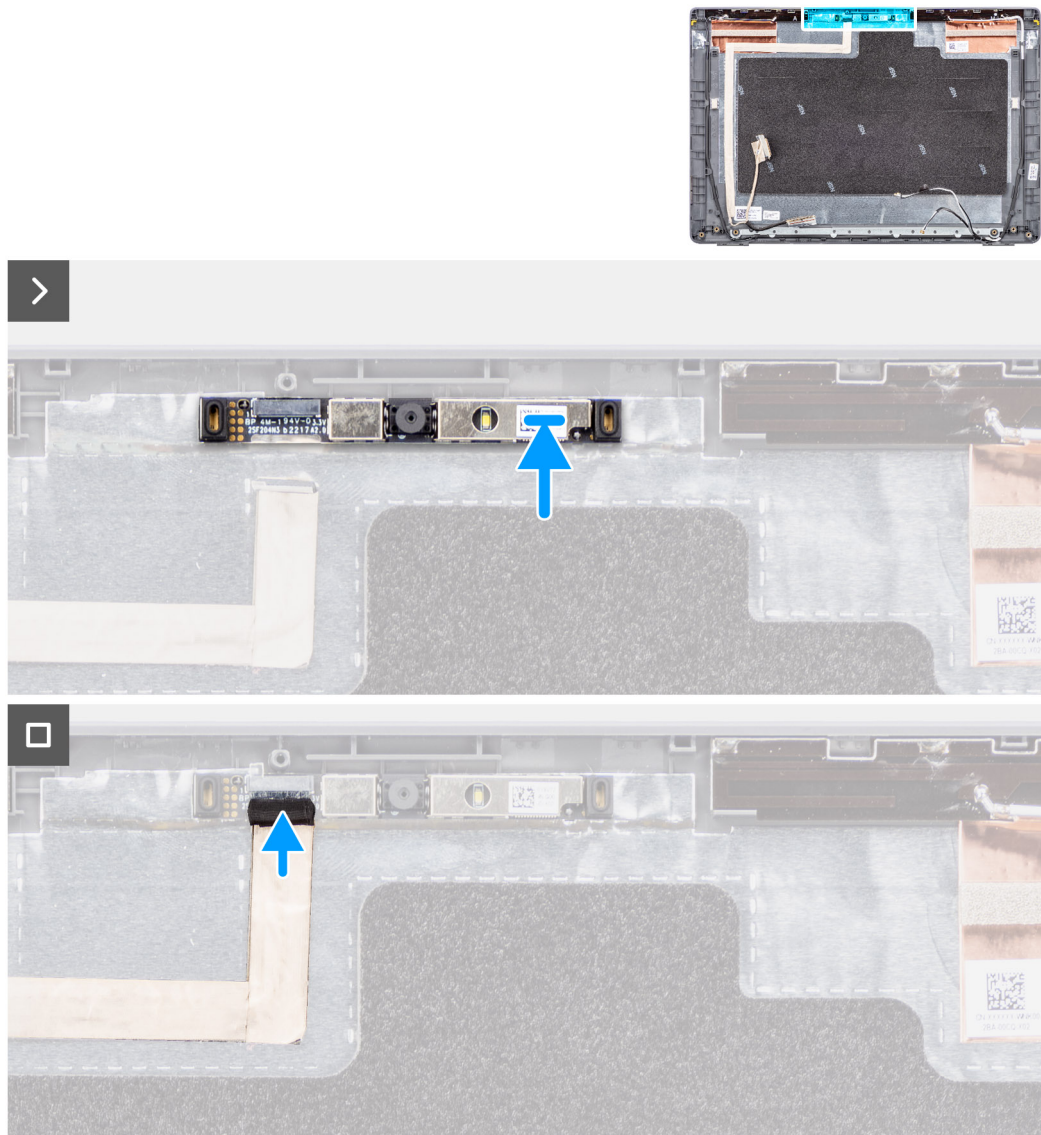
Figura 65. Installazione della fotocamera
