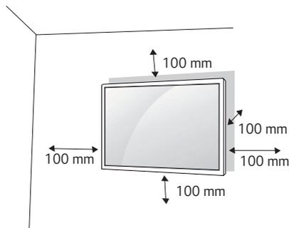
Per installare il monitor su una parete, fissare una staffa per il montaggio a parete (opzionale) al retro del monitor. Assicurarsi che la staffa per montaggio a parete sia fissata saldamente al monitor e alla parete.
