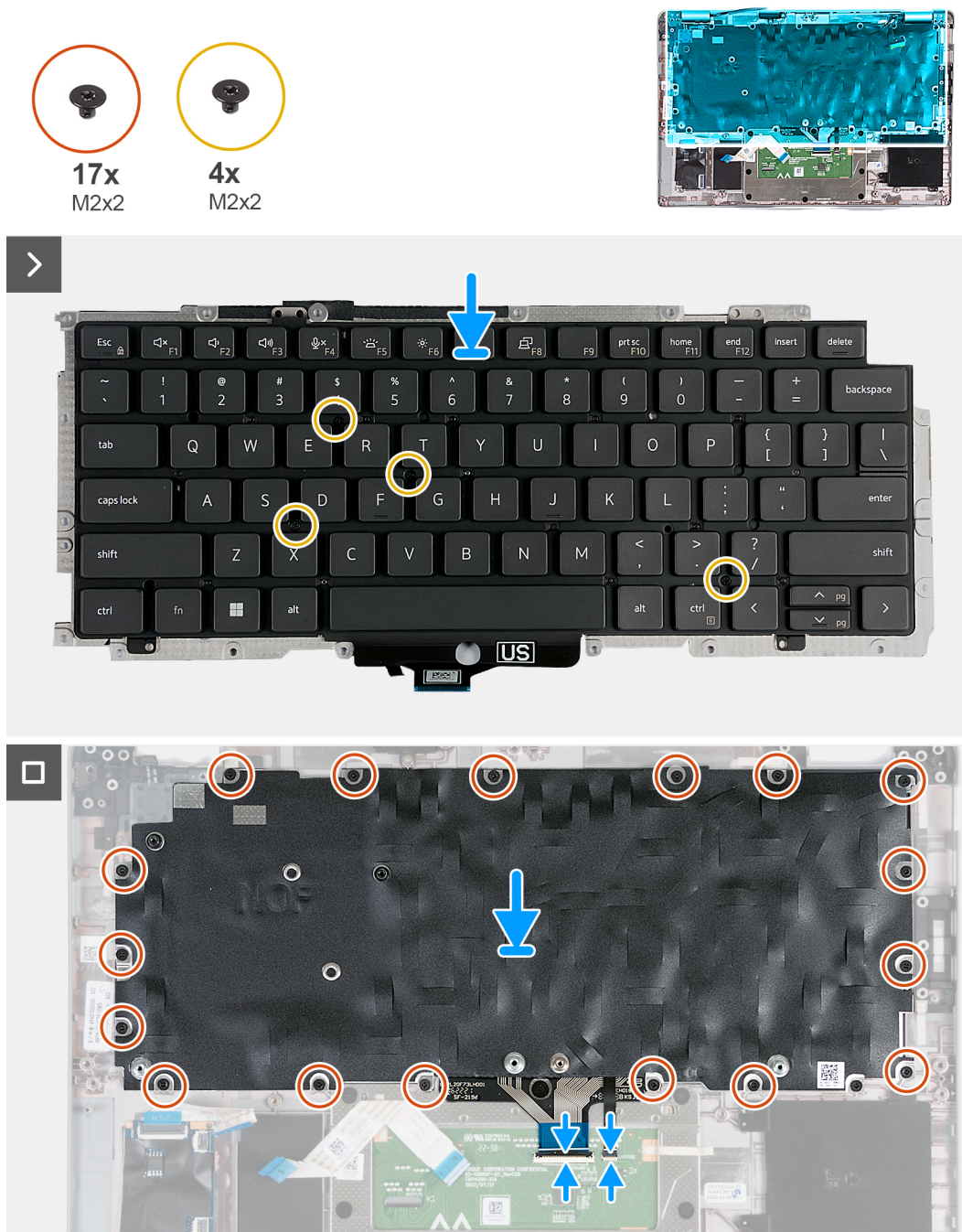
Figura 62. Installazione della tastiera
