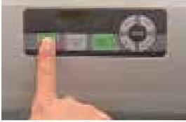
5. Drücken Sie nun die Taste »Vacuum & Seal«. Das Gerät beginnt hörbar zu arbeiten. Die Kontrollleuchte der Vakuumpumpe leuchtet rot. Die Luft wird aus dem Folienbeutel gesaugt und die Folie schmiegt sich an den Inhalt des Beutels. Wurde ein ausreichendes Vakuum erzeugt, dann leuchtet zusätzlich die Kontrollleuchte der Versiegelung (»manual Seal«) blau und der
