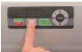
6. Drücken Sie die Taste »Manual Seal«. Das Gerät beginnt zu arbeiten. Die Kontrollleuchte der Versiegelung leuchtet blau. Der Beutelboden wird verschweißt. Sobald der Versiegelungsvorgang abgeschlossen ist, erlischt die Kontrollleuchte.
