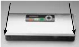
6. Drücken Sie die Öffnungstasten auf beiden Außenseiten des Gerätes, um den Deckel zu öffnen und entnehmen Sie den Folienbeutel.
